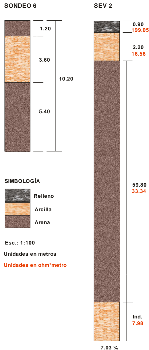
Figura 12. Correlación entre el sondeo de penetración 6 y el sondeo eléctrico 2
