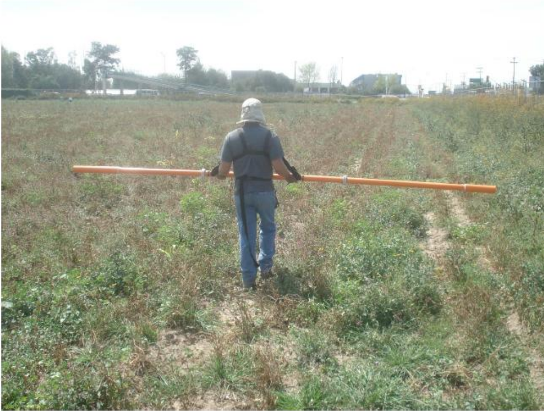
Figura 3.4 Adquisición de los datos por medio del equipo CMD-4 en la zona de estudio (Foto tomada por Vergara-Huerta, 2012).
