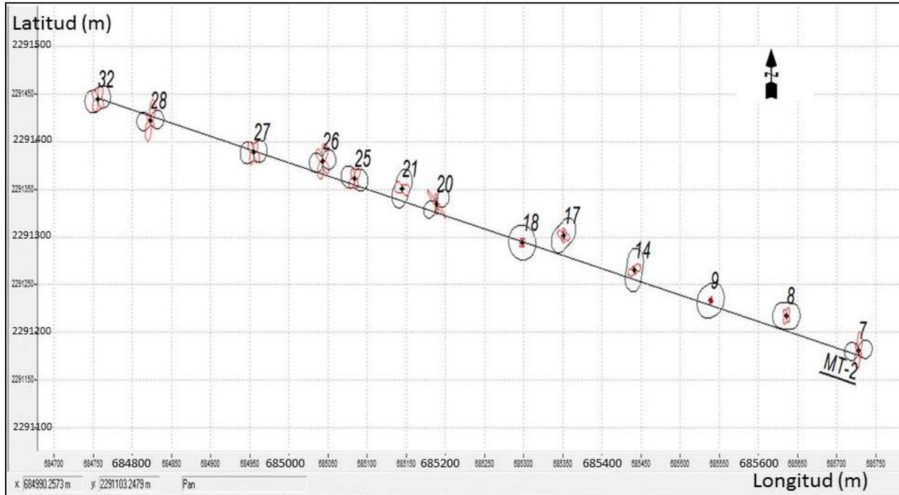
Figura 17 Diagramas polares a una frecuencia de 1000 Hz para los 13 SMT de la líneas MT-2
