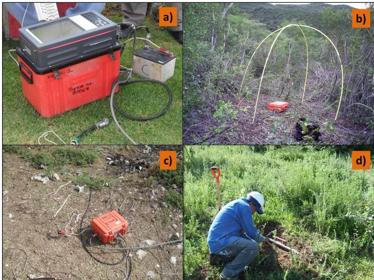
Figura 11 Implementación del equipo en campo. a) Consola Stratagem, b) Antena tipo domo, c)Equipo receptor AFE, d)Nivelación de bobinas magnéticas (Imágenes tomadas durante la adquisición en campo).
