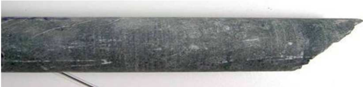
Fotografía 6.- El núcleo muestra un dique diabásico de tono gris oscuro a verdoso observándose vetillas de calcita.
