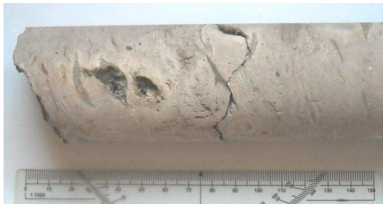
Fotografía 2.- Núcleo que muestra la Ignimbrita de la unidad Las Cruces (Tm-ic2), con oquedades rellenas de cristales de cuarzo, fiammes e indicios de corrientes de fluidez.
