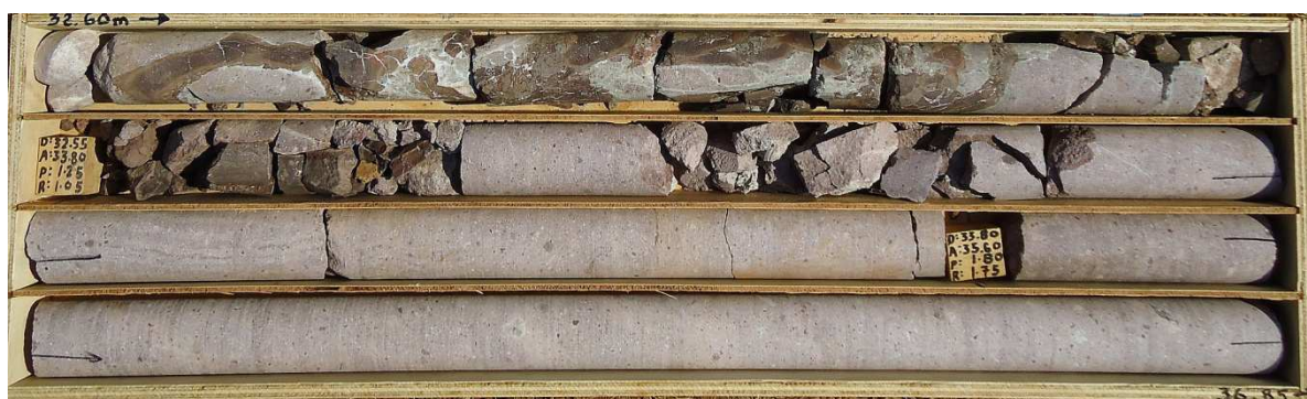
Fotografía 4.- Núcleos cortados de Ignimbritas de la unidad Corapan (Tm-ci2) de 32 a 36 m de profundidad.
