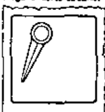
"RESTABLECER": Para restablecer el interruptor después de una desconexión, la manija se gira del centro a "restablecer".
