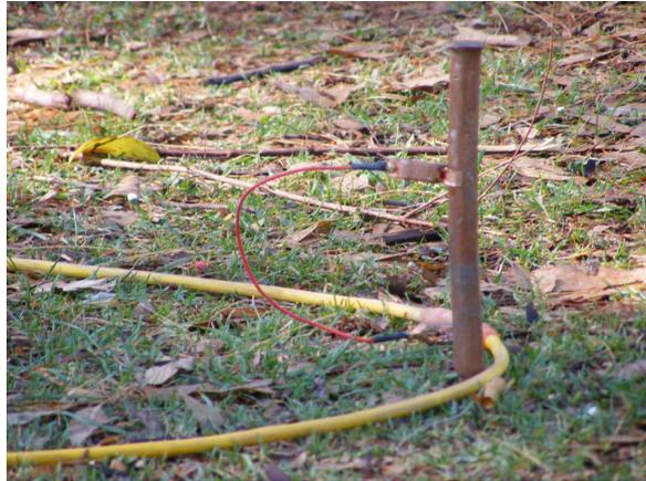
**Fotografía 2 Conexión de un electrodo**
