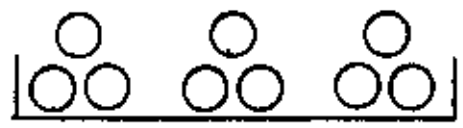
CONDUCTORES CUETEADOS POR CIRCUITO
