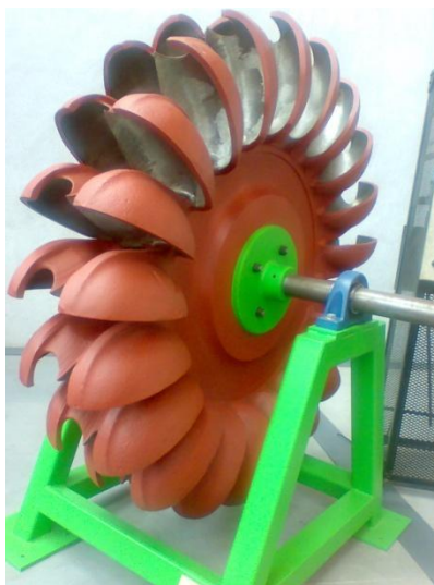
Figura 4.6 Álabes de una Turbina Hidráulica
