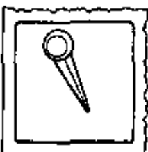
Posición de "DISPARO" (desconexión): Cuando el interruptor dispara automáticamente debido a una sobrecarga o corta-circuito.
