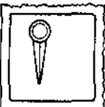
Posición de "DESCONECTADO": La manija queda en esta posición cuando el circuito está "abierto".
