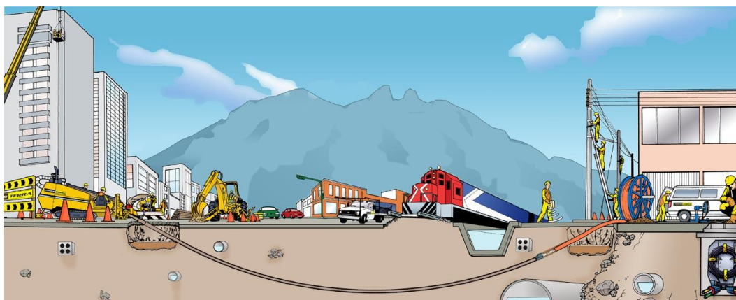
Figura 59. Crece de carreteras
