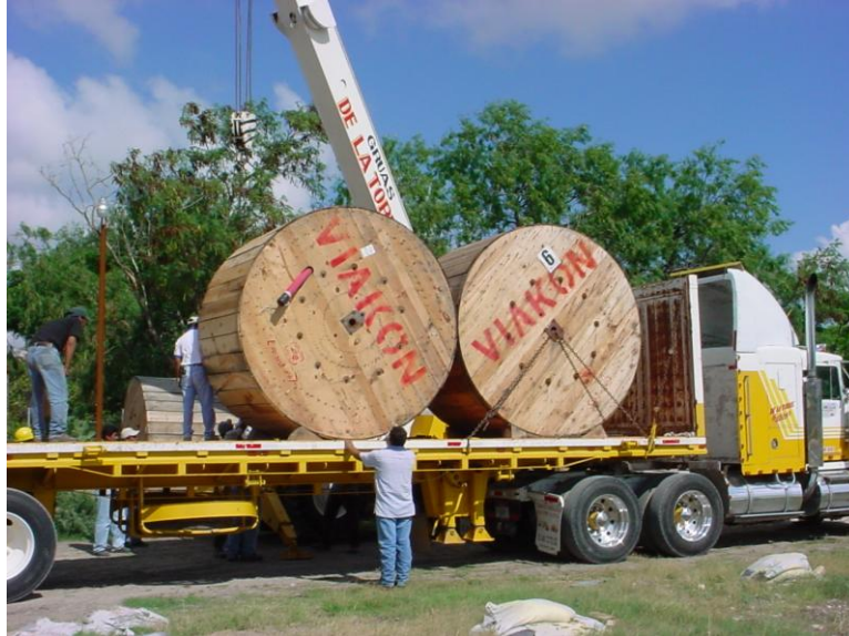
Foto 2. Posición y fijación correcta de los carretes en el medio de transporte
