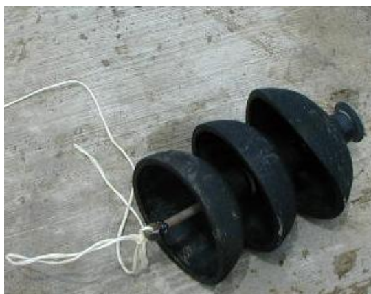
Foto 18. Guiado de ductos
