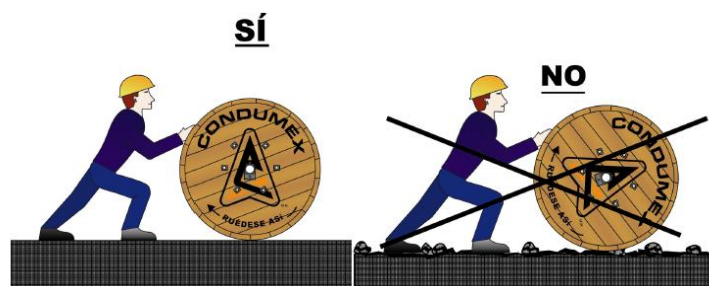
Figura 28. Forma correcta e incorrecta de rodar los carretes con cable Fuente: Conдумex. Manual técnico de cables de energía, capítulo 17
