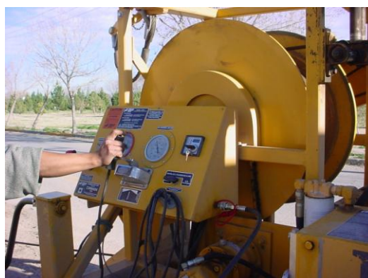
Foto 7. Tablero de control del malacate
