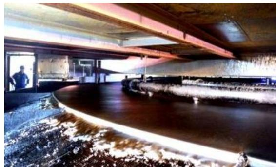
Las arenas bituminosas son transportadas a una planta de extracción tras su explotación, donde un proceso de agua caliente separa el bitumen de la arena, el agua y los minerales. La separación se lleva a cabo en células de separación como se observa en la figura 2.4.5.
