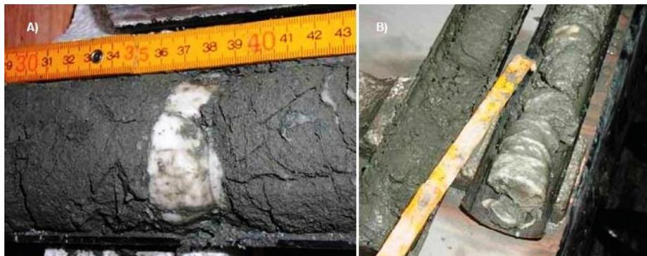
Figura 2.6.7. Núcleos de hidratos de metano masivos (Fujii, et al., 2009).
