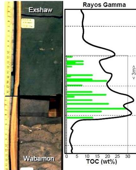
**Figura 4.1.1.** Núcleo de Exshaw; La escala de rayos gamma es de 0 a 150 API. Base de una parasecuencia rica en materia orgánica (Passey, et al., 2010).
