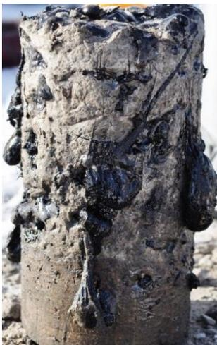
**Figura 2.4.6.** Núcleo de arenas bituminosas (Osum Corp, 2011).
