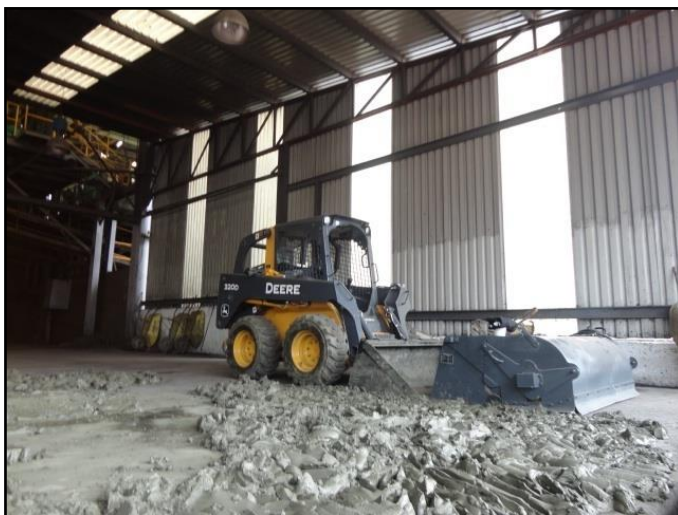
Imagen 13: John Deere mini removiendo el producto final para eliminar humedad antes del embarque
