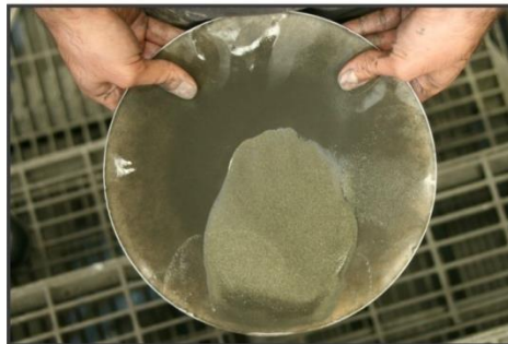
Imagen 2: Sulfuro de Cobre uno de los tres productos finales en Minera XHJ-21
