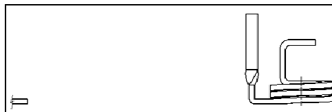
Figura 1-14. Etapa 4 Doblado de radio mayor y radio menor
