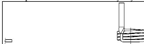
Figura 1-15. Etapa 5 Terminación del conformado de la espiral.
