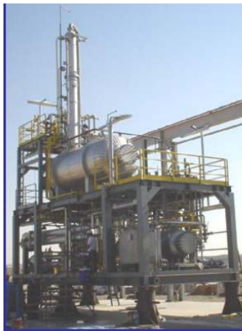
Fig.50.- Columna de destilación.
