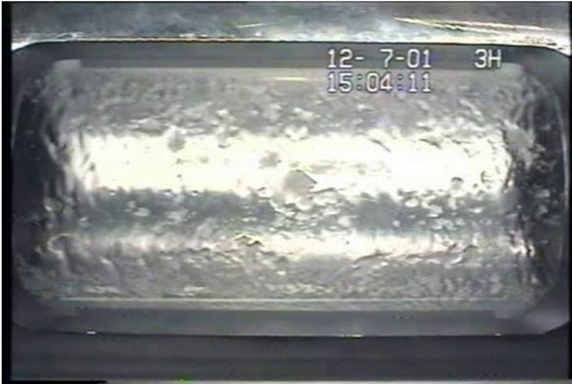
Fig. 11.-Celda para visualizar la formación de hidratos.
