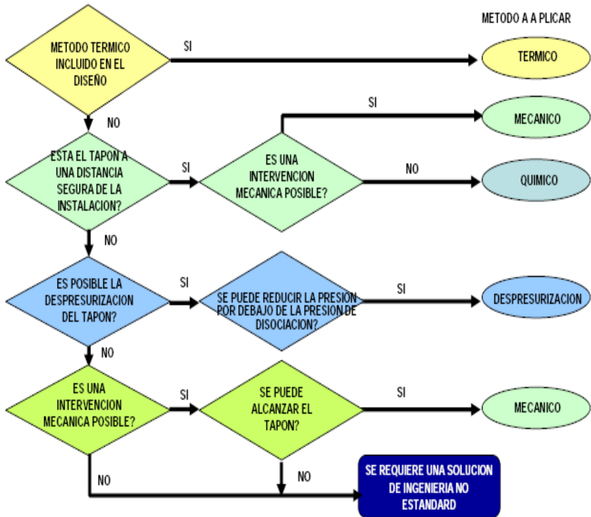
Fig. 116.- Diagrama de flujo para resolver problemas de hidratos.
