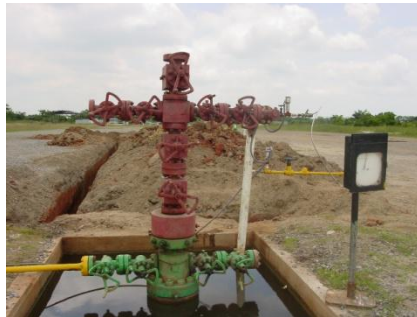
Figura 35.- Pozo Cactus 43 Operando con la Red de bombeo neumático del campo Cactus del Activo Integral Muspac
