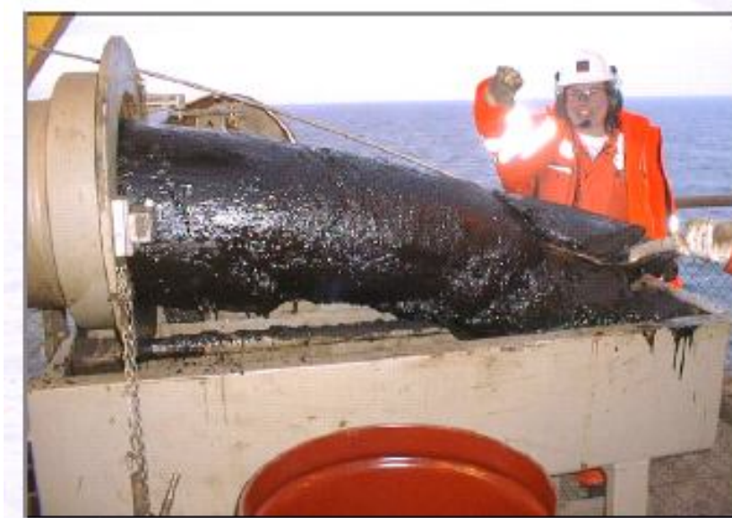
Figura 1.5. Formación de parafinas en líneas de producción (2) .
