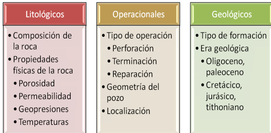
Figura 2. Criterios de selección que determinan la aplicación de los fluidos de perforación.
