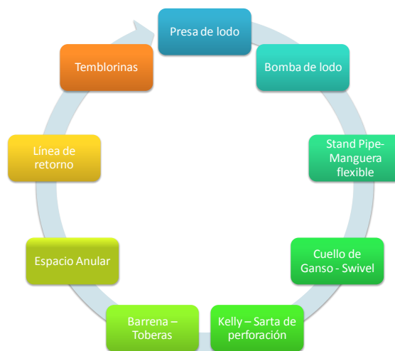
Figura 1. Diagrama general del sistema circulatorio durante la perforación.
