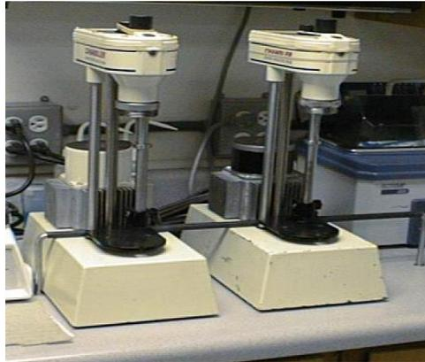
Figura 38.- viscosímetro FANN<sup>TD</sup> 35
