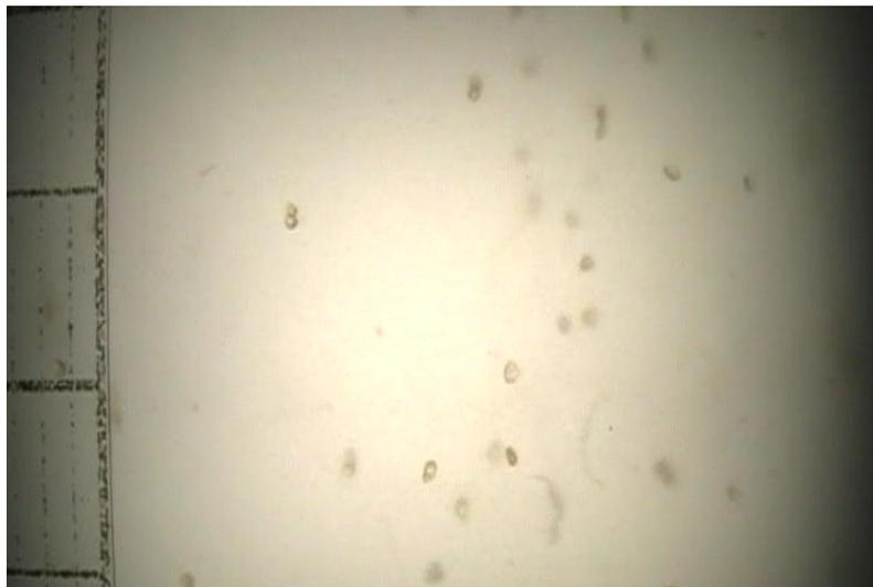
Figura 46.- Imagen del apuntalante arena sílica malla 30/50 en fluido lineal.
