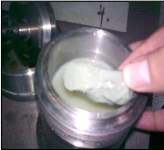
Figura 6.1A Fragmento de núcleo antes de rolar, en fluido espumado comercial
