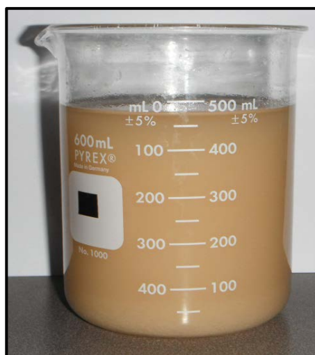
Figura 5.7B Mezcla de agua de mar, Celulosa modificada enzimáticamente, \text{CaCl}_2 , KCl y \text{Ca(OH)}_2 con dispersante
