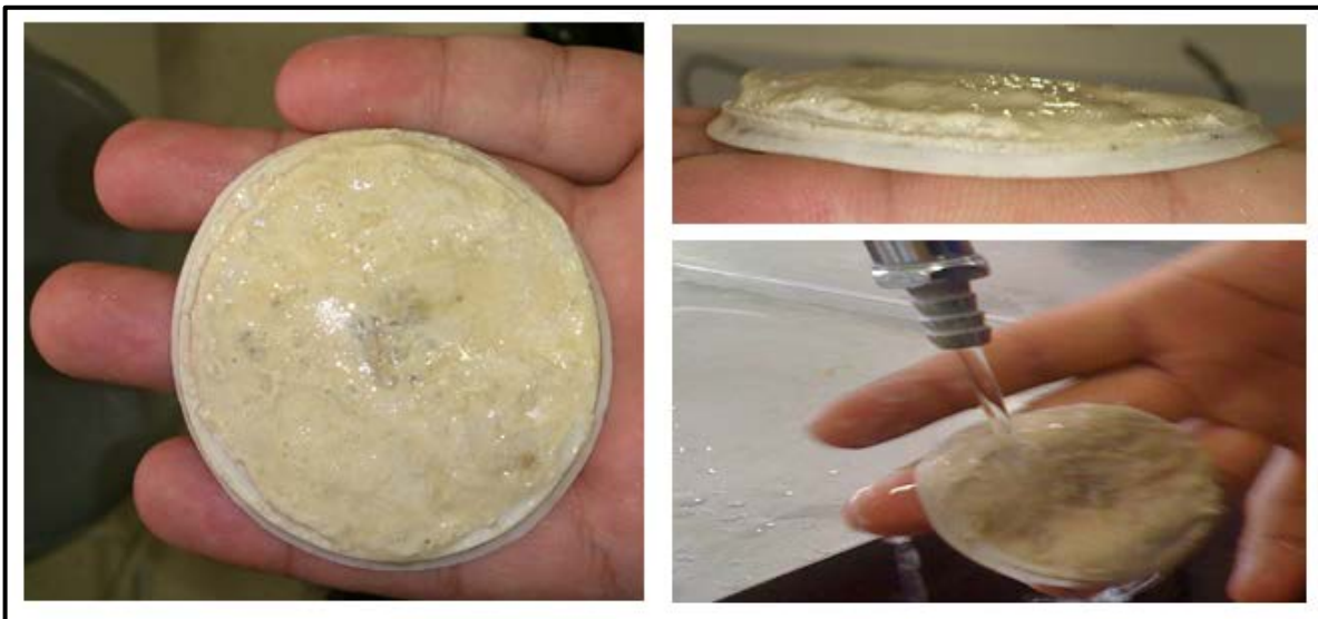
Figura 6.5 Película de depósitos finos y poliméricos generados por el fluido espumado desarrollado, durante la prueba de filtrado a alta presión y alta temperatura
