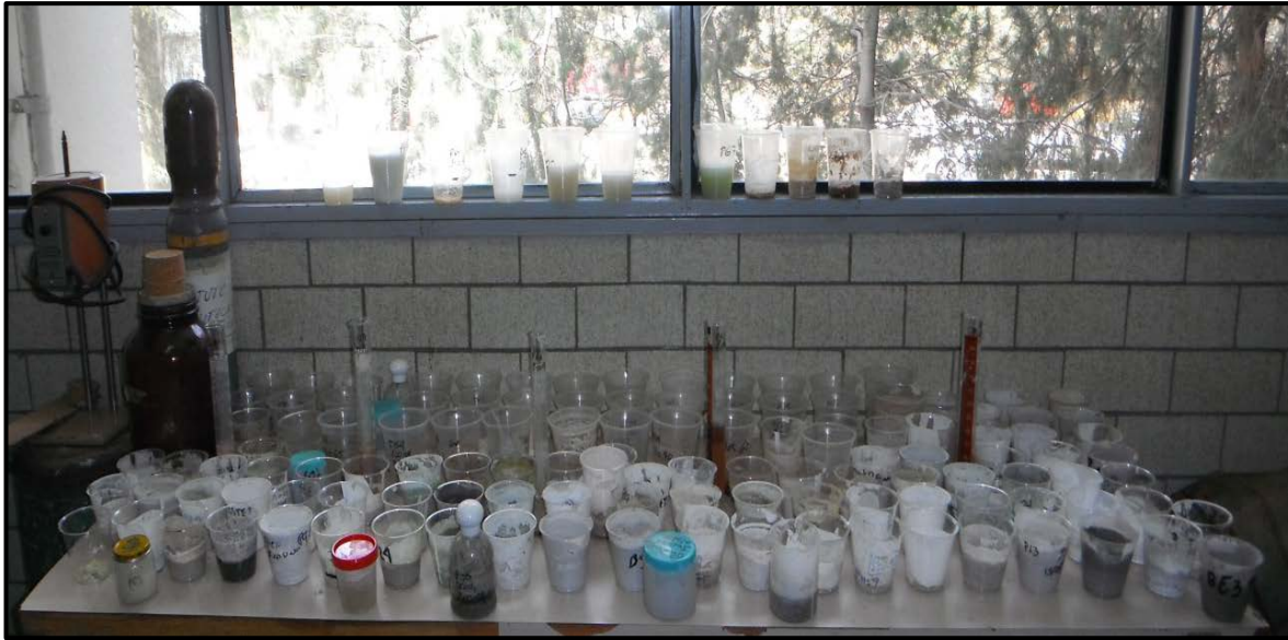
Figura 5.10 Fluidos espumados con baja estabilidad a presión y temperatura ambiente
