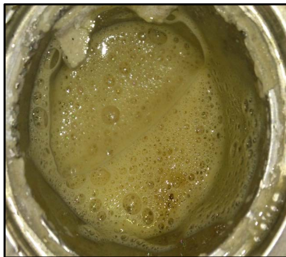
Figura 6.4 Fluido espumado después de la prueba de filtrado APAT, a 100°C y 500 psi, durante 30 minutos.
