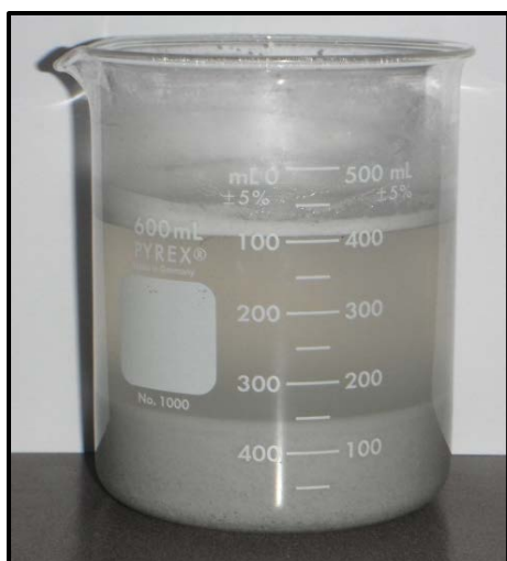
Figura 5.7A Mezcla de agua de mar, Celulosa modificada enzimáticamente, \text{CaCl}_2 , KCl y \text{Ca(OH)}_2 sin dispersante
