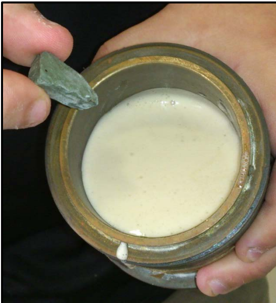
Figura 6.2A Fragmento de núcleo antes de rolar, en fluido espumado desarrollado
