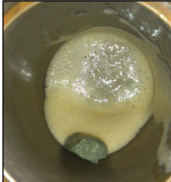
Figura 6.2B Fragmento de núcleo después de rolar, en fluido espumado desarrollado
