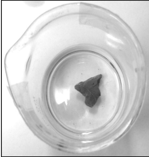
Figura 5.11A Fragmento de núcleo de la formación Paleoceno Inferior en seno de Propilenglicol
