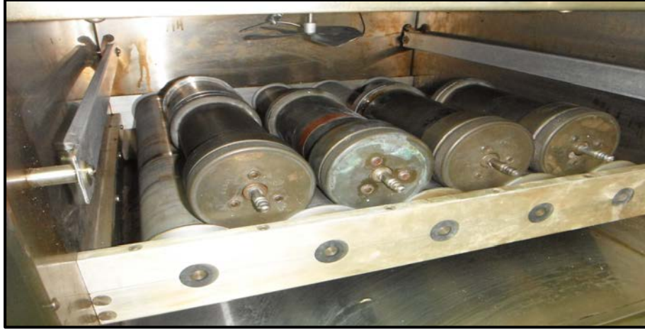
Figura 5.12 Equipo de rolado, con celdas de acero selladas herméticamente
