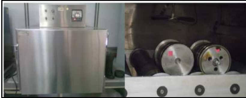
Figura 5.21 Prueba de Interacción roca-fluido en estado dinámico.
