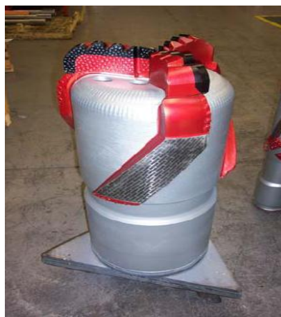
Figura 3: Zapata perforadora DS 2
