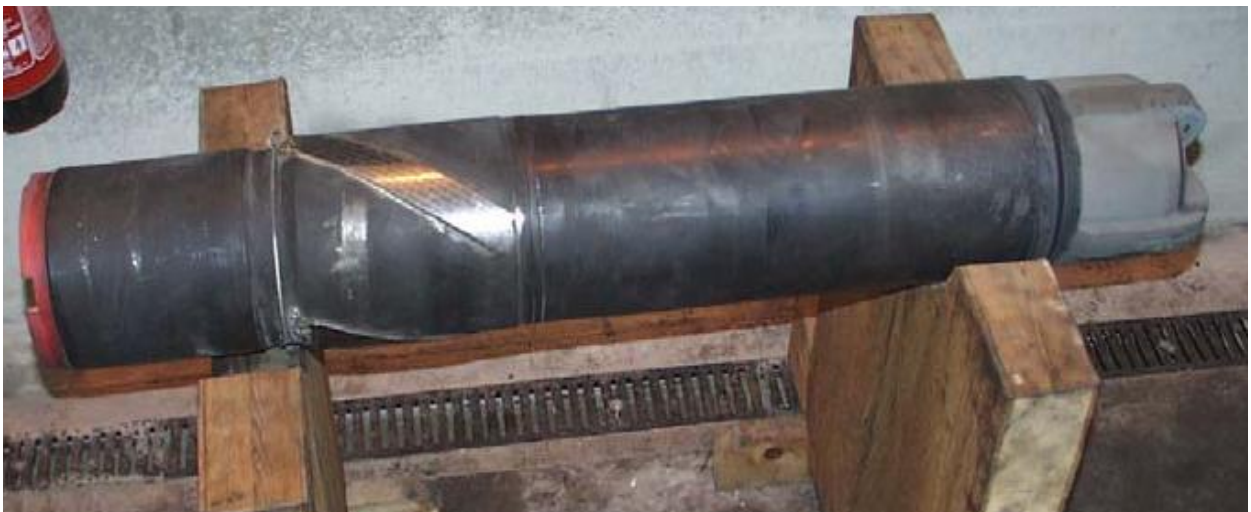
Figura 6: Estabilizador y Estructura Principal
