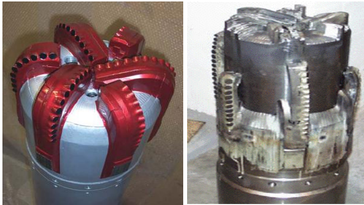
Figura 32: Zapata perforadora antes y después de expansión
