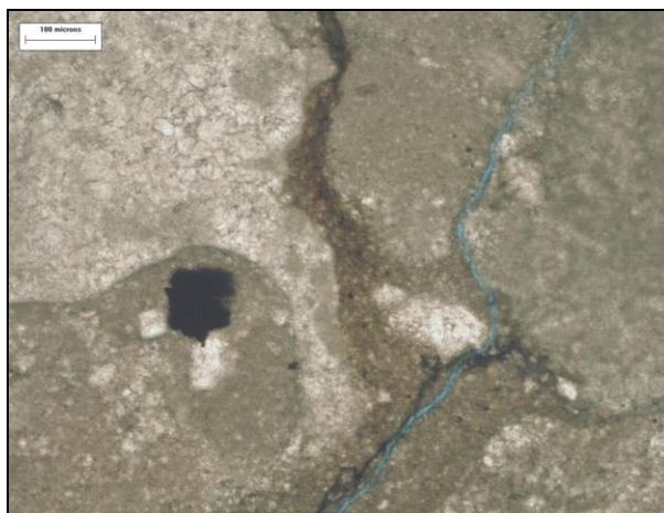
Figura V.8.-Microfotografía del núcleo-1 correspondiente al Cretácico, correspondiente a una Brecha carbonática según la clasificación de Dunham 1962, observándose en color azul microfractura abierta.
