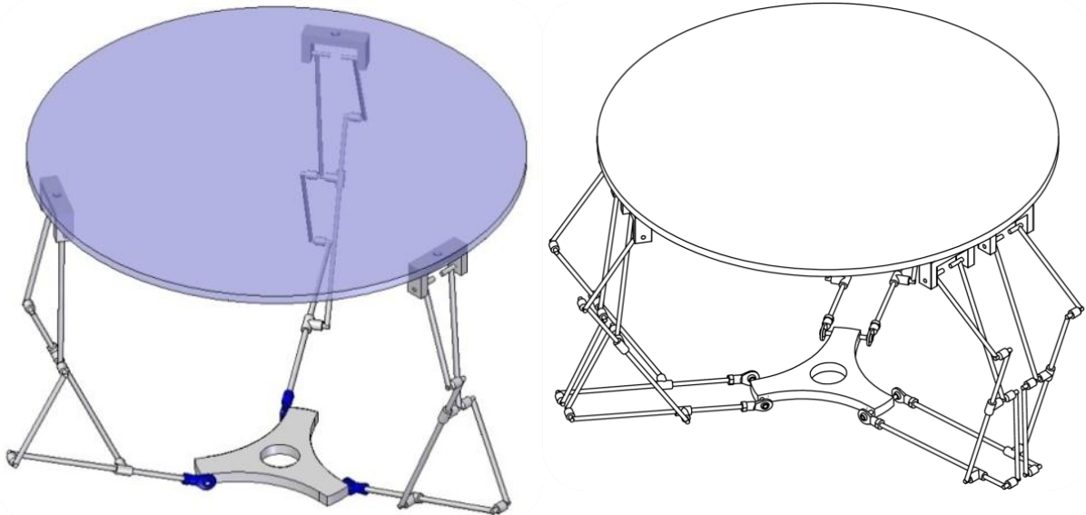
Figura 39 Mecanismos propuesto con redundancias cinemáticas; a la izquierda se muestra el mecanismo redundante con tres cadenas cinemáticas independientes y 9 GDL; el mecanismo de la derecha tiene seis cadenas cinemáticas independientes y 12 GDL
