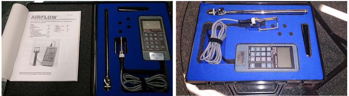
Figura 38 Dispositivo utilizado en la medición de velocidades y temperaturas dentro del cuarto.
