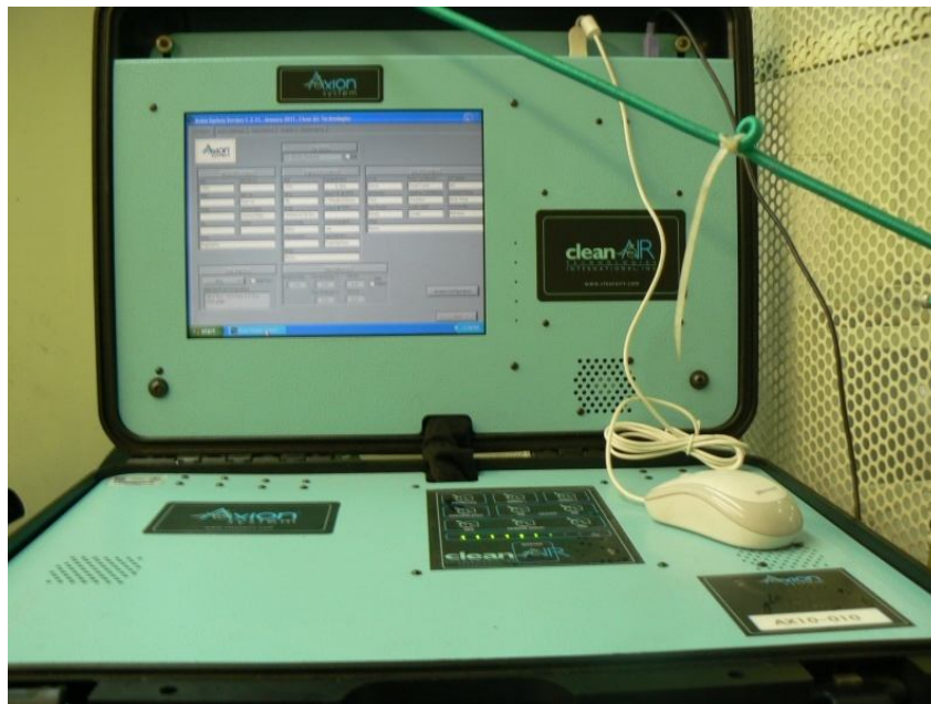
Figura 2.16 a) Imagen de archivo, Sistema de Medición de Emisiones Portátil, PEMS-OEM-2100AX Axion (12).
