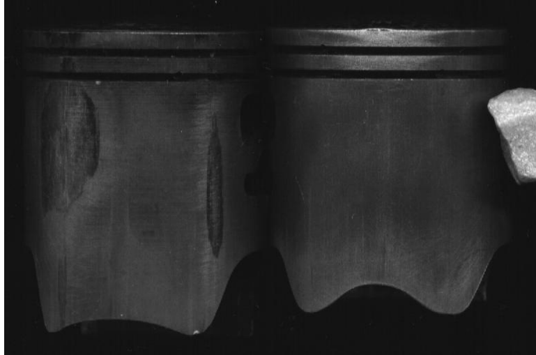
Figura 4.7 Pistón de falda larga y Pistón de falda corta
