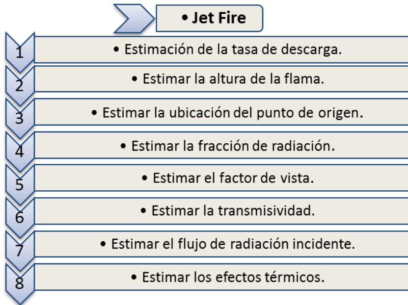
Figura 2.10- Diagrama lógico para el cálculo de los efectos de radiación debido a un chorro de fuego.
