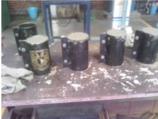
**Figura 3.8 Vaciado de concreto al molde**
