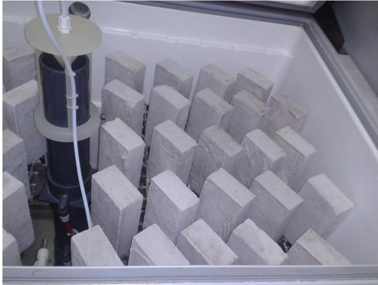
**Figura 3.17 Probetas prismáticas en cámara de carbonatación**
