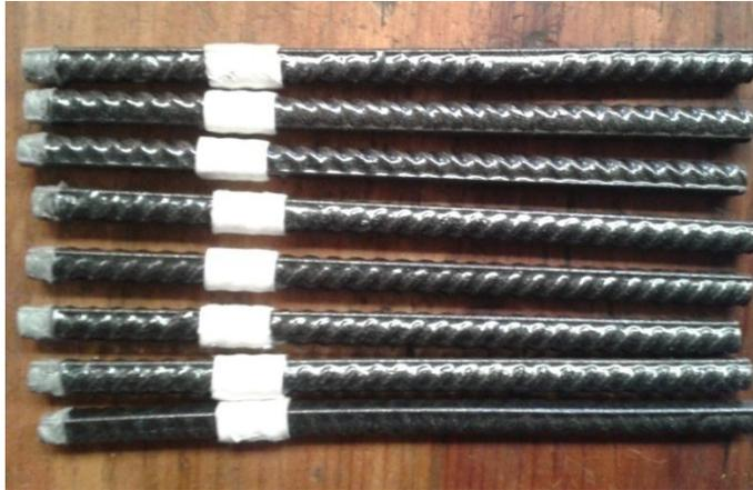
**Figura 3.13 Varillas con recubrimiento de pintura epóxica más oxido laminar**
