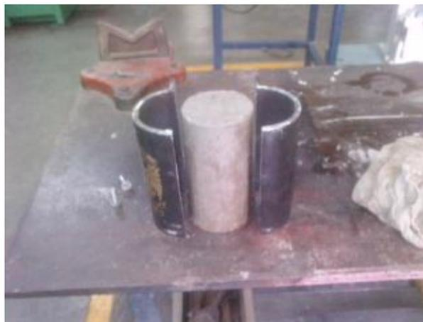
**Figura 3.9 desmolde de probetas**
