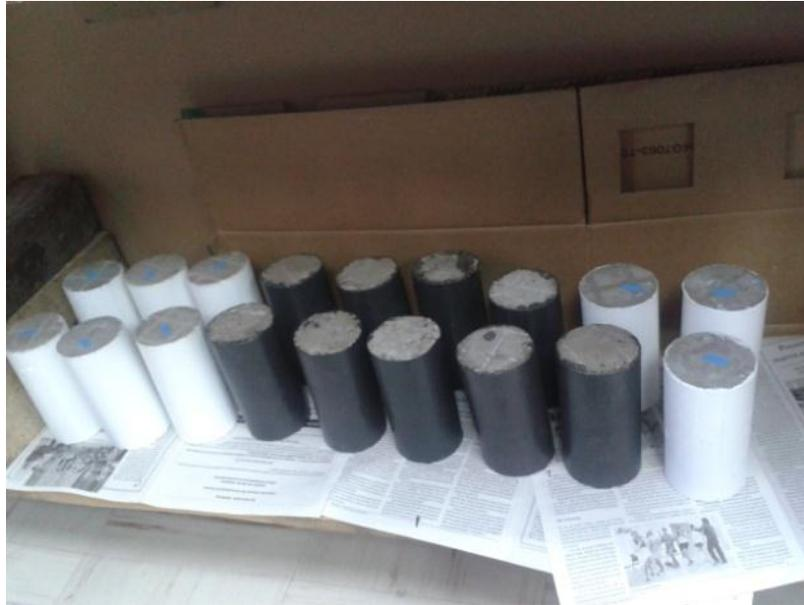
**Figura 3.11 A. pinturas epóxicas**
