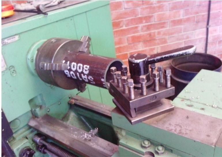
**Figura 3.2 Refrentado de los cilindros**
