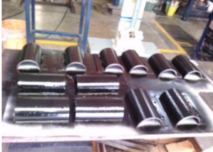
**Figura 3.6 Aplicación de laca a los moldes**
