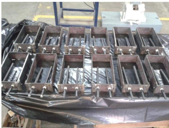
**Figura 3.14A Colocación de la varilla dentro del molde**
