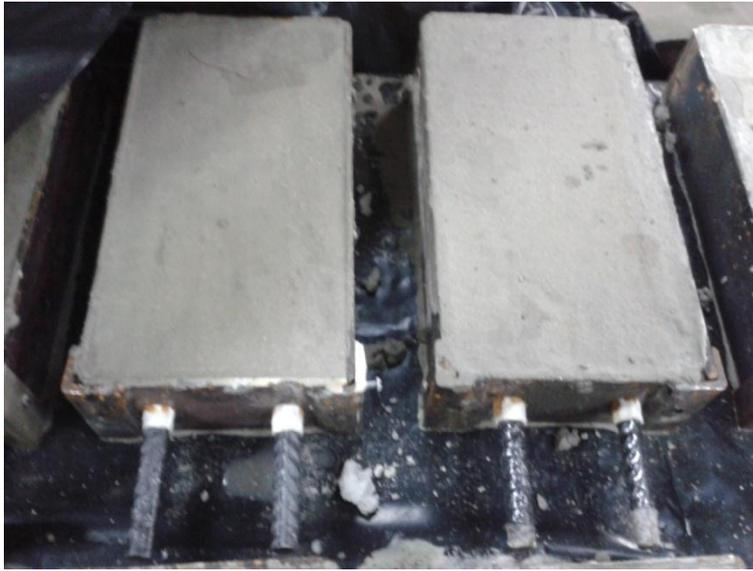
**Figura 3.14B Llenado de moldes con el concreto.**
