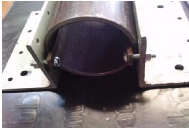
**Figura 3.3 Dispositivo de sujeción**
