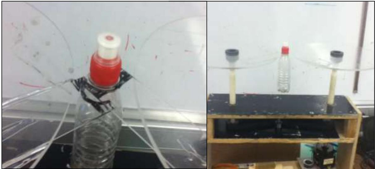
**Ilustración 46** Simulador de rotor prueba de sujeción.
