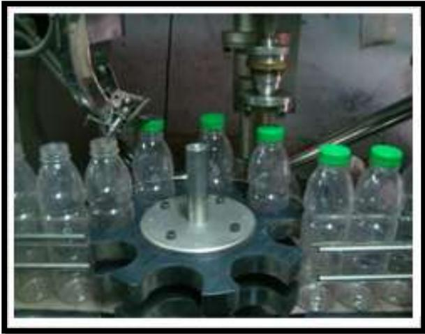
**Ilustración 13 Cabezal de tapado [18]**
