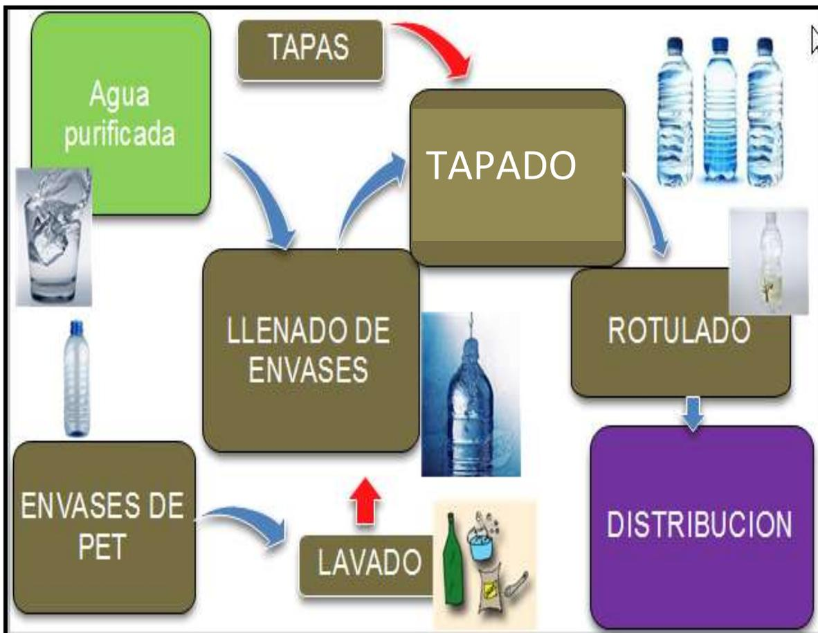
Ilustración 5. Proceso de Envasado de Agua.
