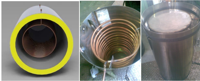
Figura 33: Diseño y construcción del termotanque.
