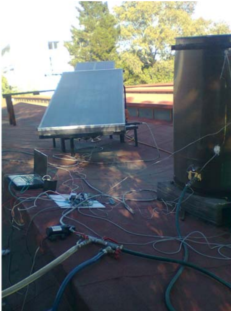
Figura 53: Integración de los subsistemas y pruebas del prototipo.
