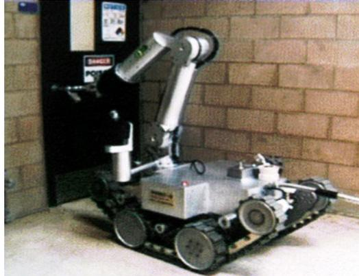
Figura 1.6: Robot telecontrolado para desactivación de explosivos.
