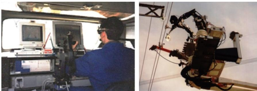
Figura 1.12: Prototipo Robtet para el mantenimiento de líneas de alta tensión.
