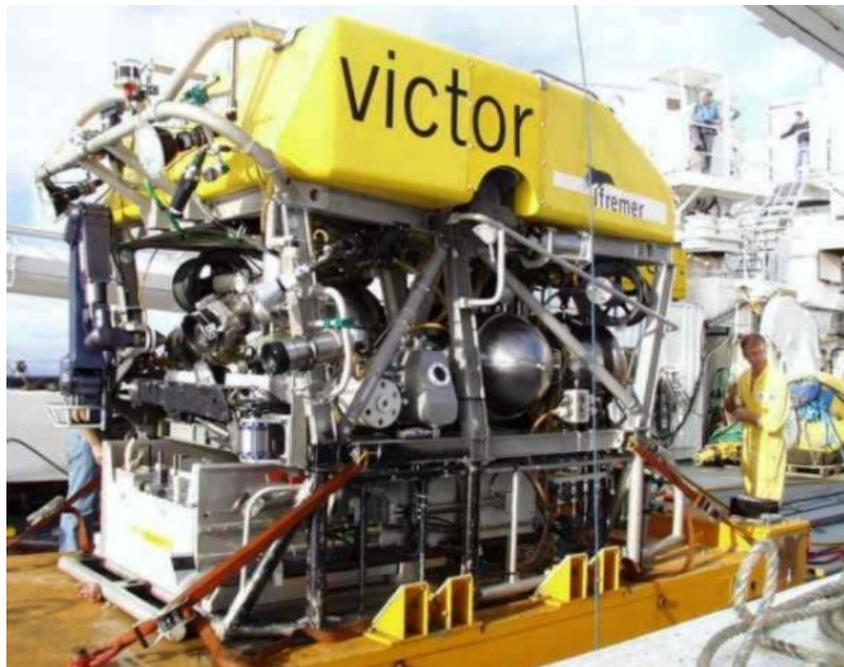
Figura 1.3: Robot teleoperado de exploración submarina.
