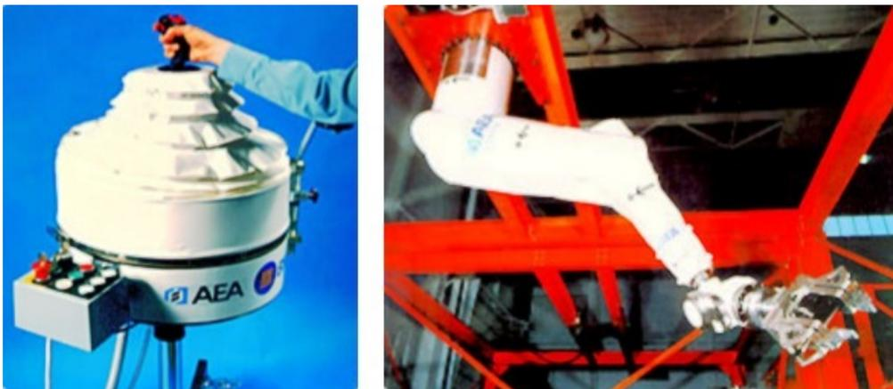
Figura 1.2: Robot maestro(izq) - esclavo(der) para plantas nucleares.
