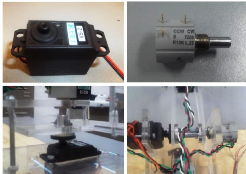
Figura 5.3: Motores, potenciómetros y acoplamientos utilizados. Fuente: [3]
