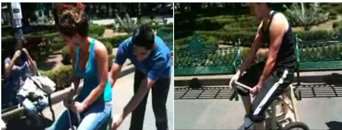
Imagen 56. Pruebas de operación con manubrio central bajo.
