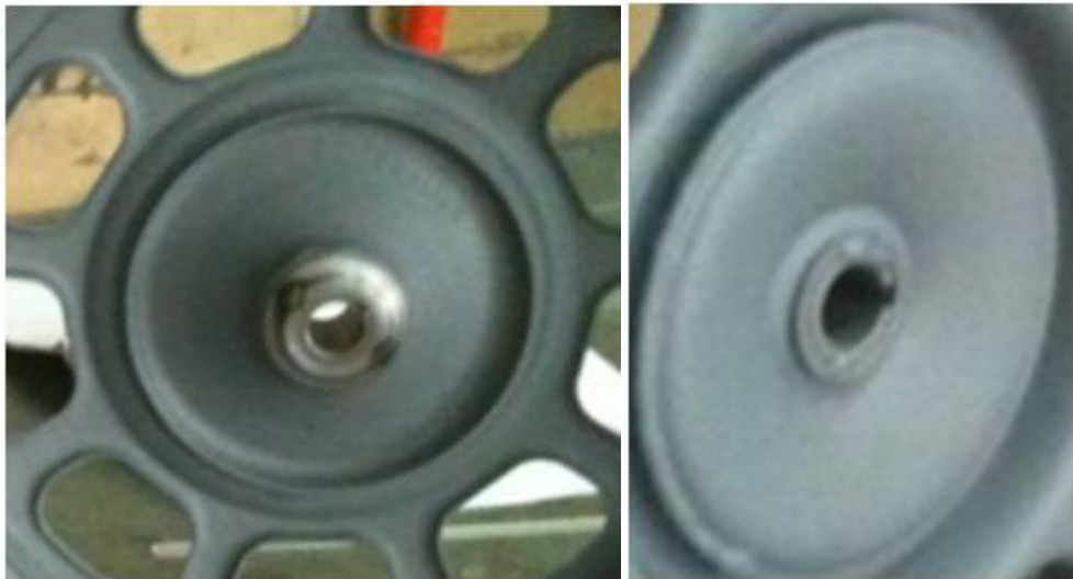
Imagen 76. Bujes maquinados a la medida para acoplar las llantas con los motores.
