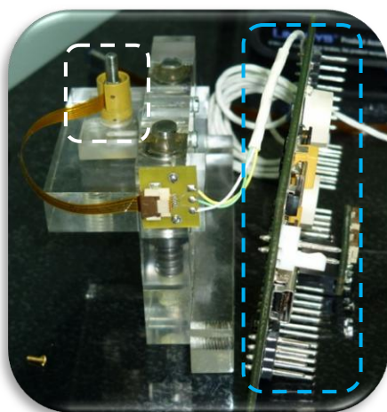
Figura 1.5 Detalle de motor piezoeléctrico en blanco, y detalle de control PID en azul.
