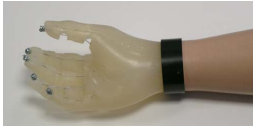
Figura 3.28: Mano protésica diseñada y fabricada con una variante de silicón, la cual tiene un giro monocéntrico y un solo grado de libertad en su articulación MCF. [41]
