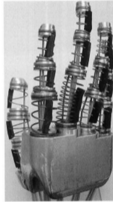
Figura 3.26: Aquí se puede apreciar el tipo y distribución de los resortes que conforman esta prótesis de mano. [29]
