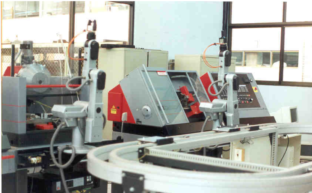
Figura 7. 1 Celda de manufactura flexible, de los talleres de ingeniería mecánica.
