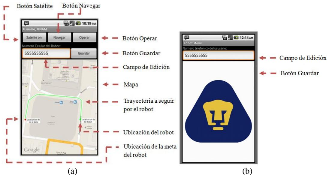
**Figura 2.** Pantalla principal del "Smartphone" del usuario (a) y del robot móvil (b).
