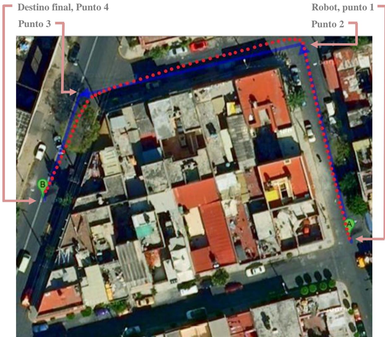
Figura 4.11. Trayectoria de referencia en azul y trayectoria realizada por el robot en rojo para más de dos puntos.
