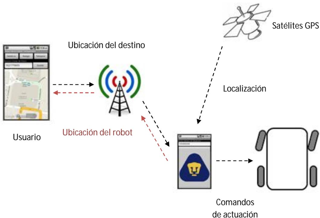
Figura 2.1. Diagrama del sistema a implementar.
