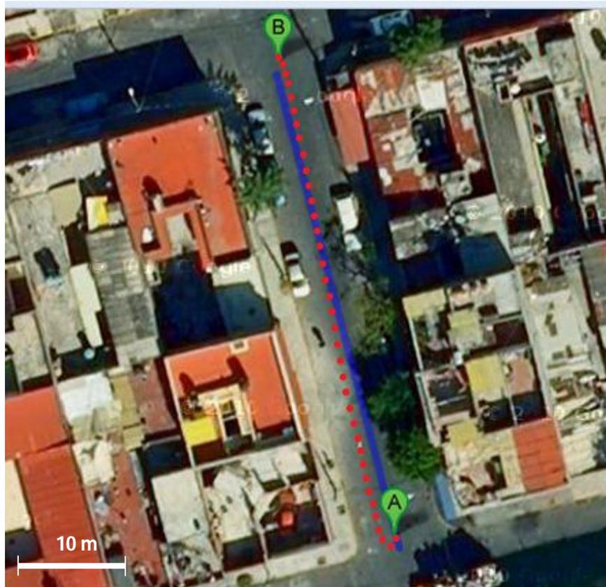
Figura 4.8. Trayectoria de referencia en azul y trayectoria realizada por el robot móvil en rojo.
