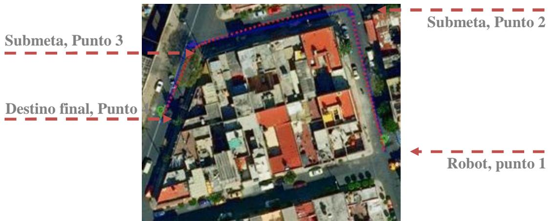
**Figura 7.** Trayectoria de referencia en línea azul y trayecto realizado por el robot en puntos rojos
