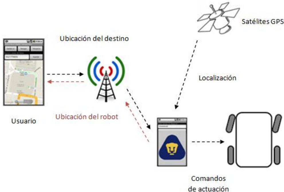
**Figura 4.7. Diagrama del sistema a implementar.**
