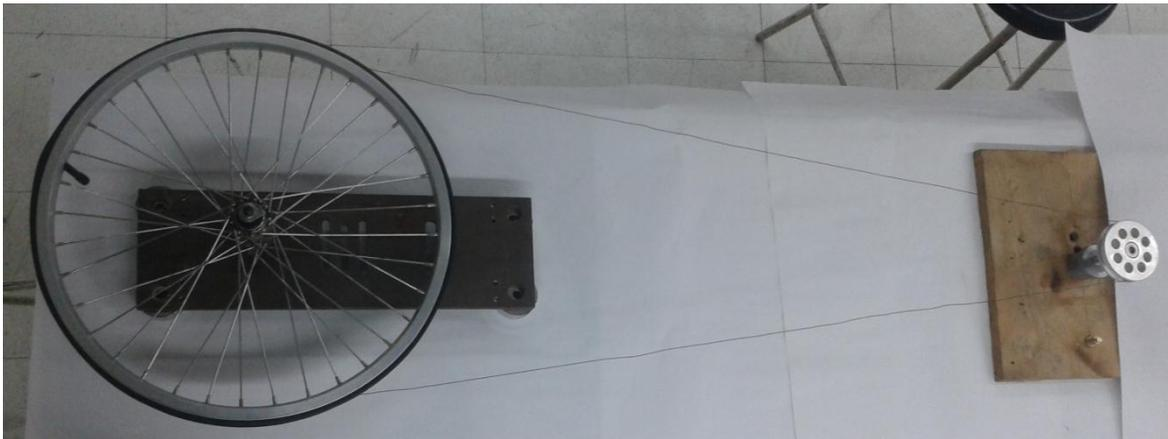
**Figura 3.26** Sistema de impulsión usando MMF.
