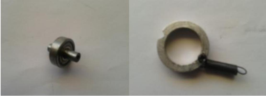
**Figura 3.4** Rodamiento y ensamble del resorte-anillo
