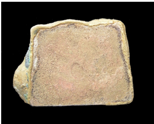
Figura 5.16. Capa enriquecida obtenida en la probeta luego de 4 ciclos de procesamiento, observada desde la cara de control.
