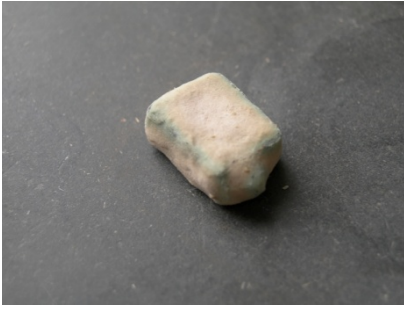
Figura 4.4. Probeta deformada, recubierta de pintura de zirconio para evitar oxidación excesiva durante el recocido de recristalización.
