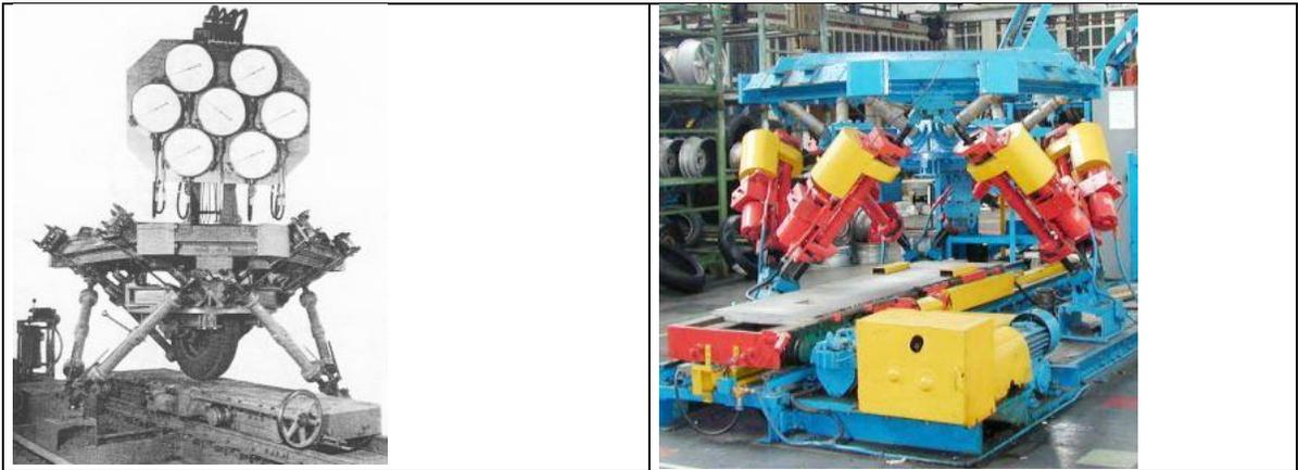
Figura 1.3 Robots paralelos tipo plataforma.
