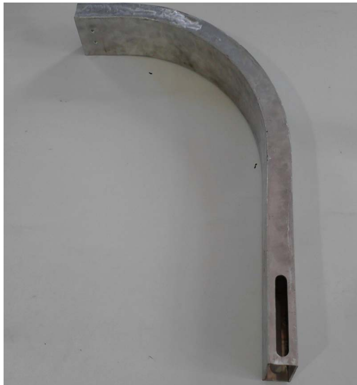
Figura 6.2 Brazo B_1 del esparcómetro obtenido después de un proceso de soldadura.
