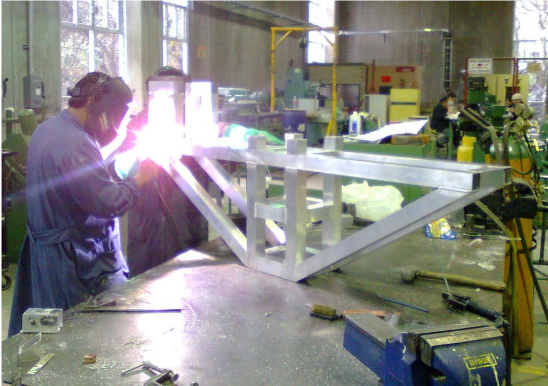
Figura 6.3 Trabajadores del CCADET realizando la soldadura del brazo G.
