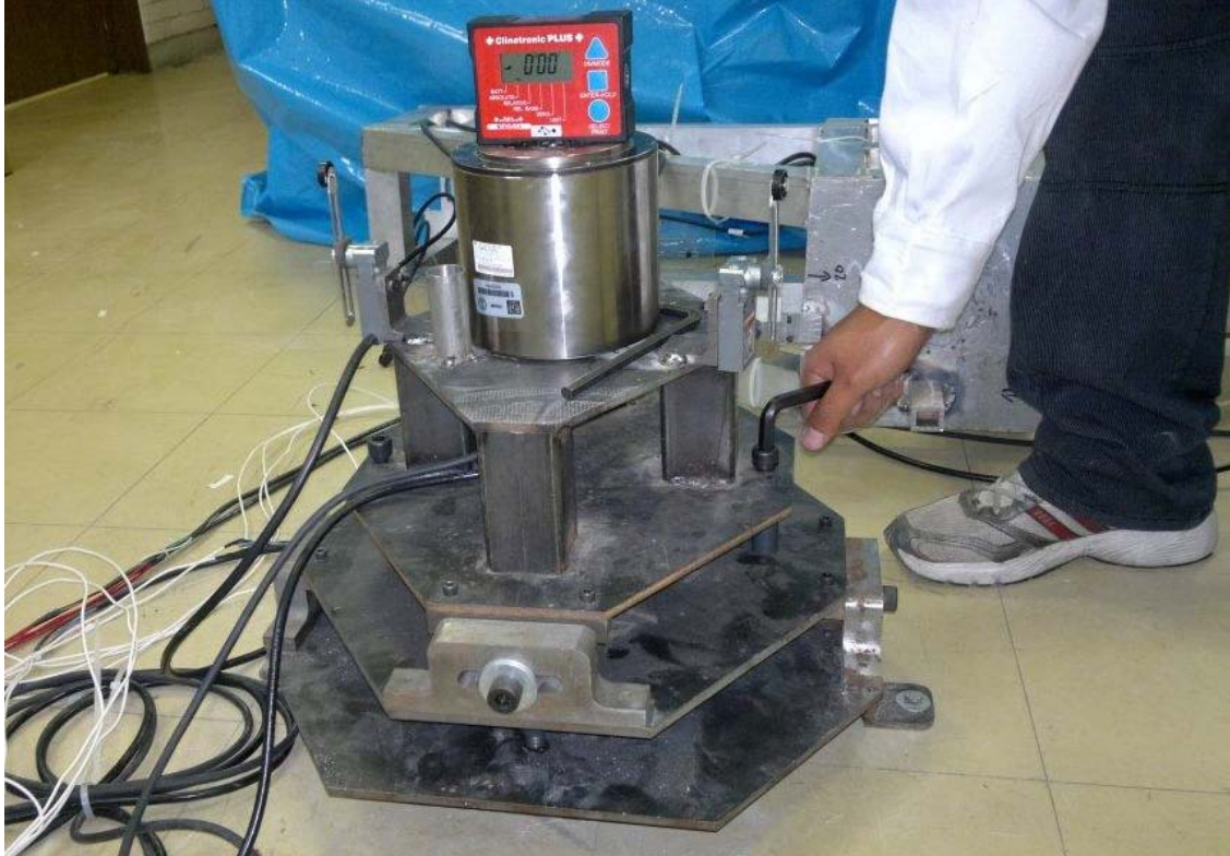
Figura 6.12 Alineación del eje de giro del servomotor del brazo G. En la parte superior del servomotor se muestra el equipo de metrología midiendo una inclinación cero.
