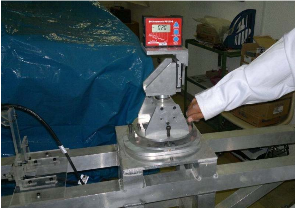
Figura 6.13 Alineación del eje de giro del mecanismo de sujeción de la muestra.
