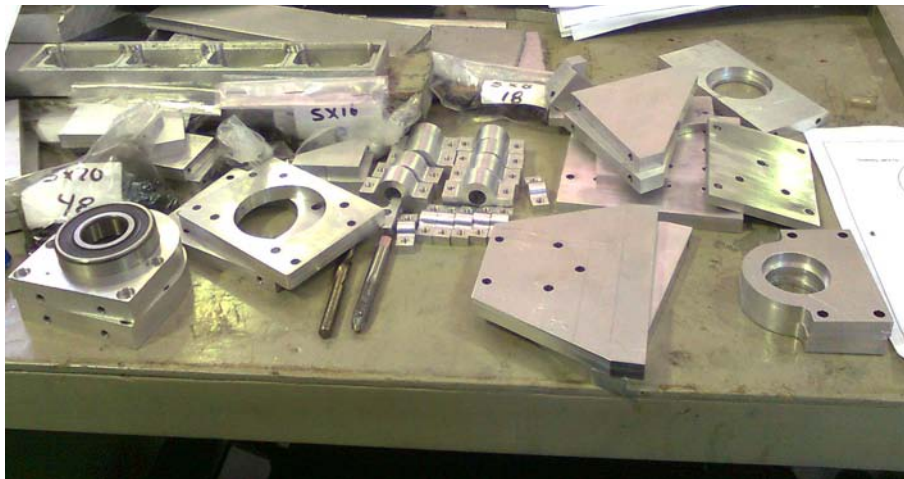
Figura 6.4 Diversas piezas del esparcímetero obtenidas por medio de CNC.
