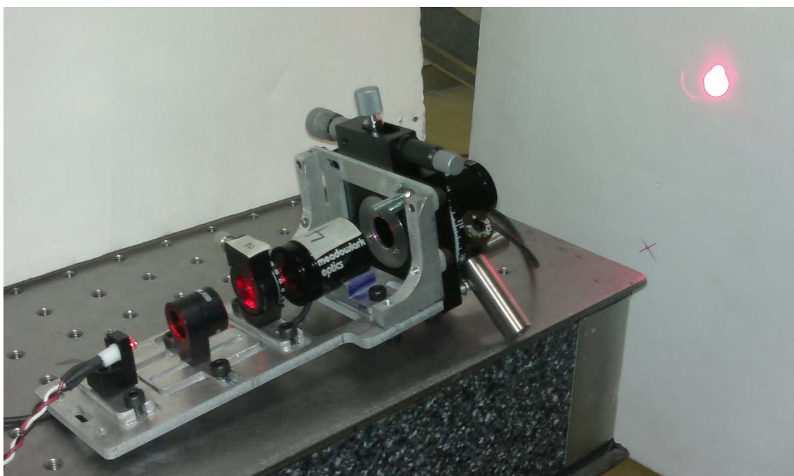
Figura 6.8 Ensamblaje del mecanismo de alineación M5 y los componentes ópticos del láser.
