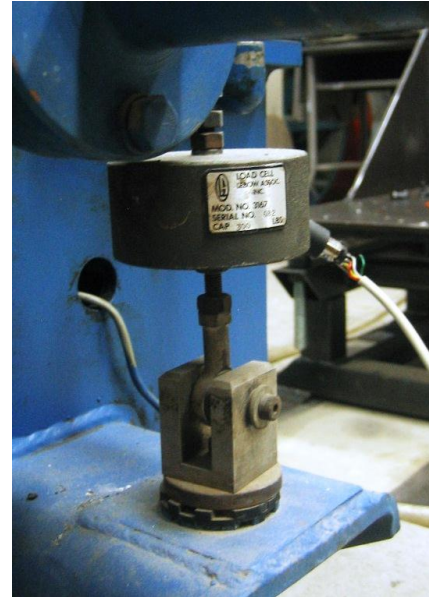
Figura 23. Celda de carga instalada en el dinamómetro
