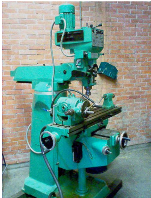
Fig.2.10 Fresa OIMSA FTX-8 Utilizada para la rectificación de placas primarias.
