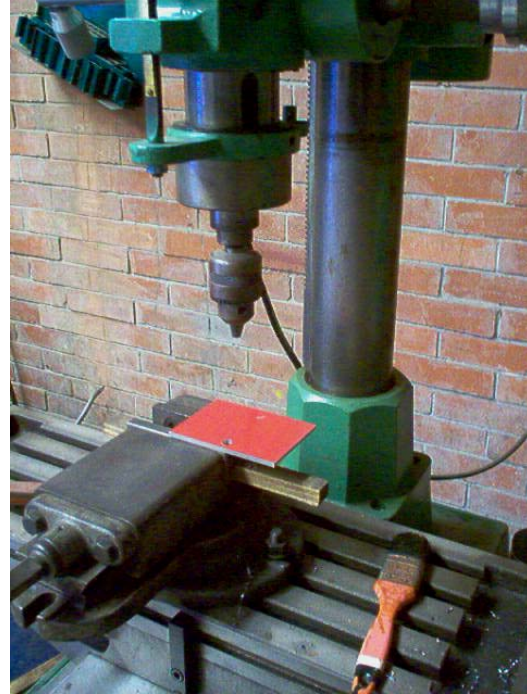
Fig. 2.12 Taladro fresador vertical WT, utilizado para los barrenos de sujeción de las probetas.
