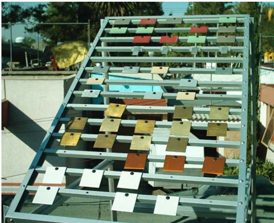
Fig. 2.21 Bastidor para pruebas de corrosión atmosférica montado en el ambiente urbano a los tres meses de exposición, en donde se aprecia claramente la colocación y tratamientos de las probetas en estudio.
