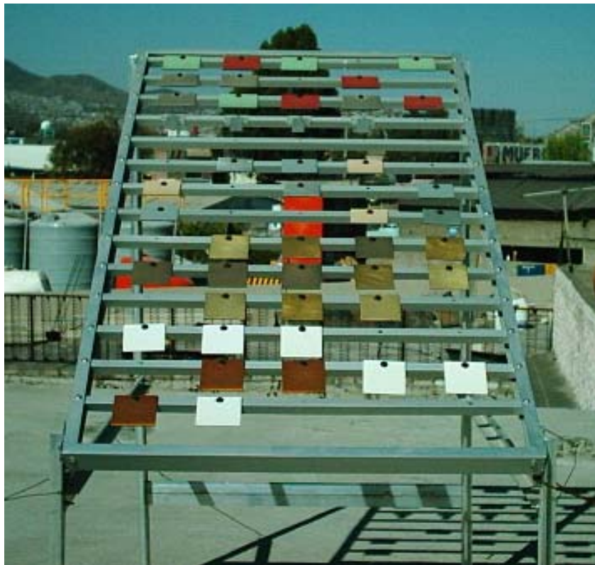
Fig. 2.22 Bastidor para pruebas de corrosión atmosférica montado en el ambiente industrial a los tres meses de exposición, en donde se aprecia claramente la colocación y tratamientos de las probetas en estudio.
