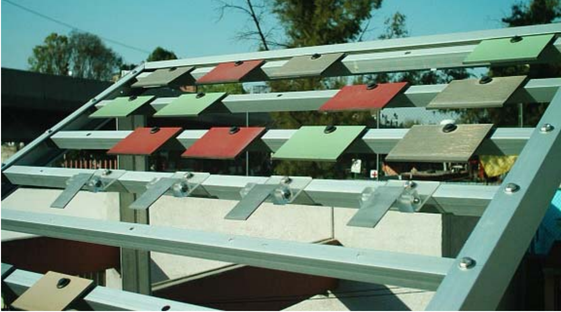
Fig. 2.24 Monitoreo al tercer mes en la estación “Merced”, donde se aprecia el correcto posicionamiento de las probetas y los efectos causados en los recubrimientos de las mismas por los diversos contaminantes de la zona, así como el asentamiento de ellos sobre la superficie.
