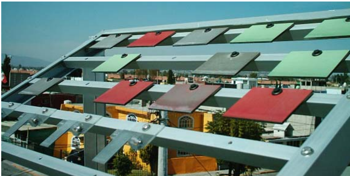
Fig. 2.23 Monitoreo al tercer mes en la estación "Villa de las Flores", donde se aprecia el correcto posicionamiento de las probetas y los efectos causados en los recubrimientos de las mismas por los diversos contaminantes de la zona, así como el asentamiento de ellos sobre la superficie de las placas.
