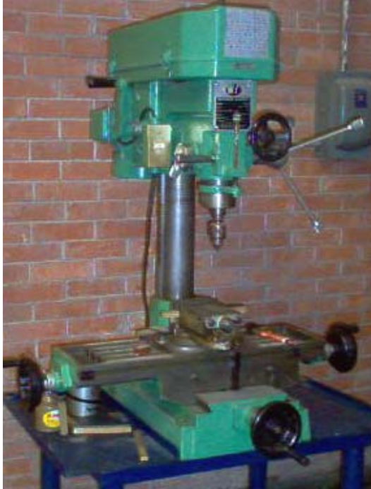
Fig. 2.12 Taladro fresador vertical WT, utilizado para los barrenos de sujeción de las probetas.
