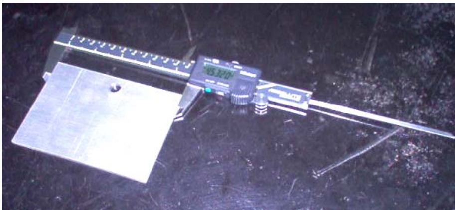
Fig. 2.16 Las imágenes muestran un espécimen de doble cara sin recubrimiento durante el proceso de medición de sus dimensiones con un vernier electrónico Mitutoyo CD-6" C, donde se denota que el instrumento provee cuatro cifras singnificativas,
