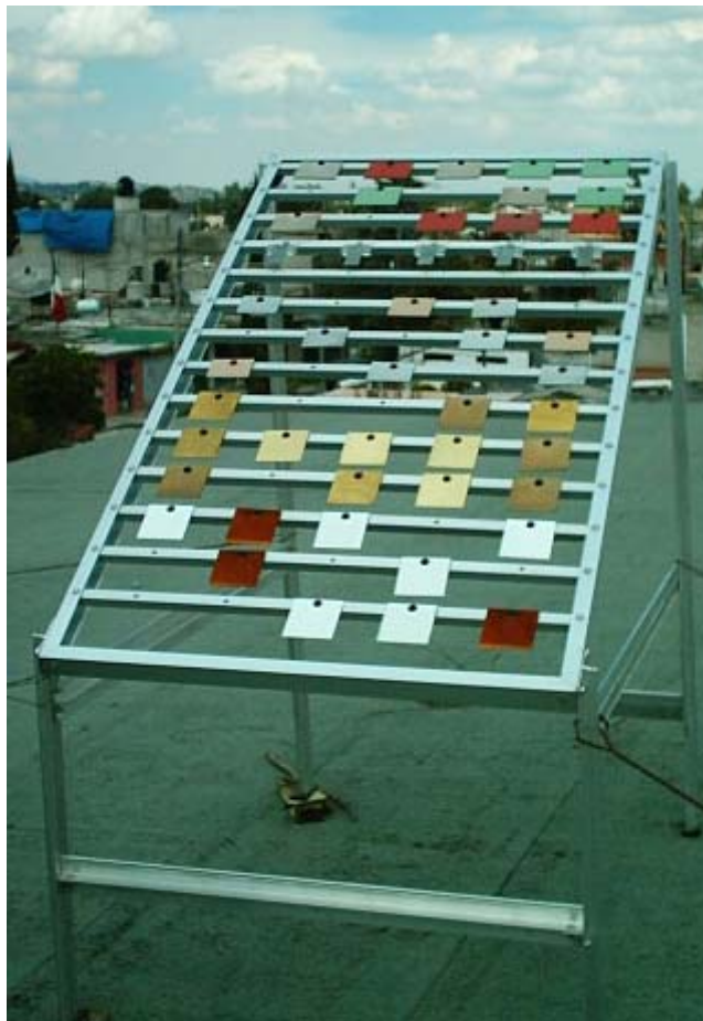
Fig.2.20 Bastidor para pruebas de corrosión atmosférica montado en el ambiente rural a los tres meses de exposición, en donde se aprecia claramente la colocación y tratamientos de las probetas en estudio.
