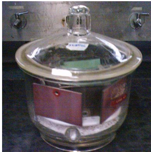
Fig. 2.27 Pesaje y deshidratación de especímenes para la cuantificación de pérdida de masa. a) Balanza analítica utilizada en el pesaje y equipo de cómputo para el registro del mismo. b) Deshidratador de calcio usado para la eliminación de humedad en las muestras.
