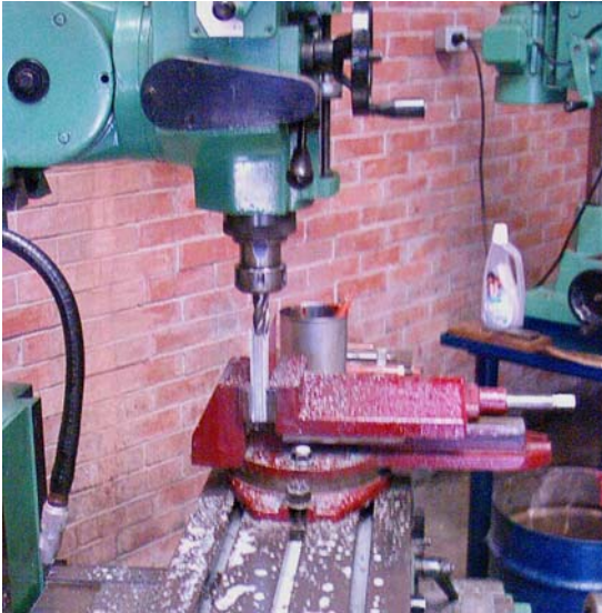
Fig. 2.11 Proceso de rectificación para homogeneización.
