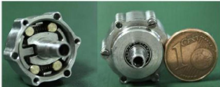
Fig. 4.18 Mecanismo de bloqueo de la Smart Hand [57]
