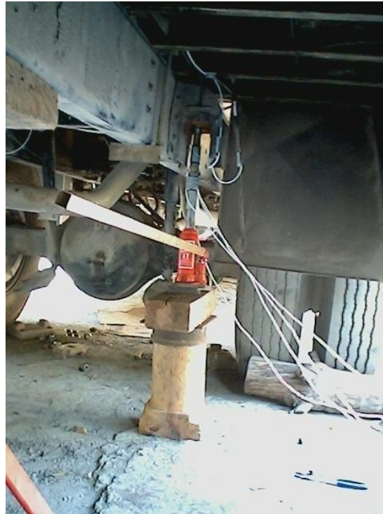
Fig. 4.6. Método de calibración de la percha.
