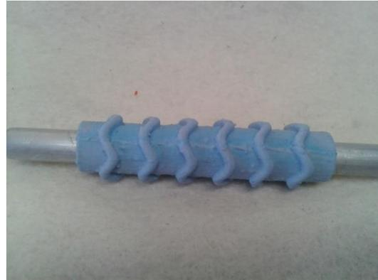
Figura 34. Primer vaciado de Stent en material flexible
