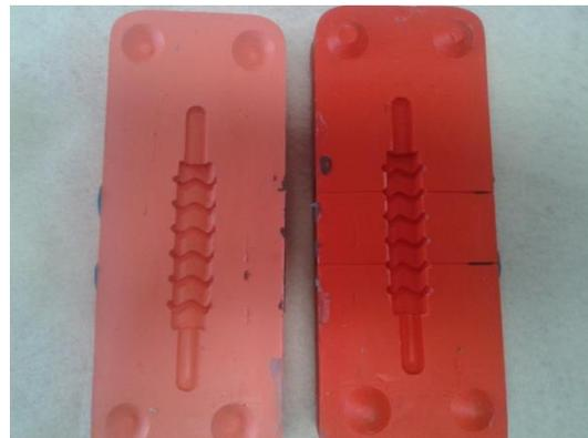
Figura 36 Molde definitivo Stent
