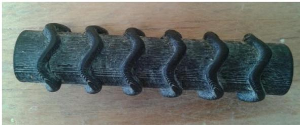
**Figura 29. Estelitografía Stent**
