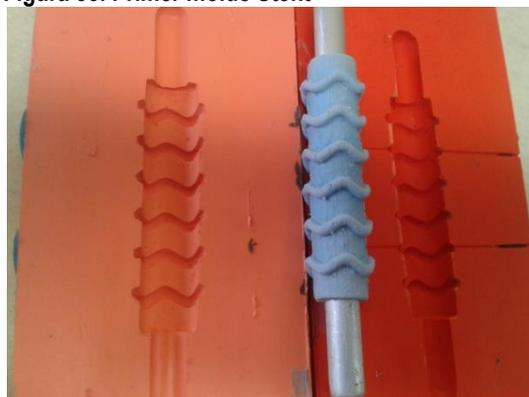
Figura 35 Molde Stent con corazón altamente deformable
