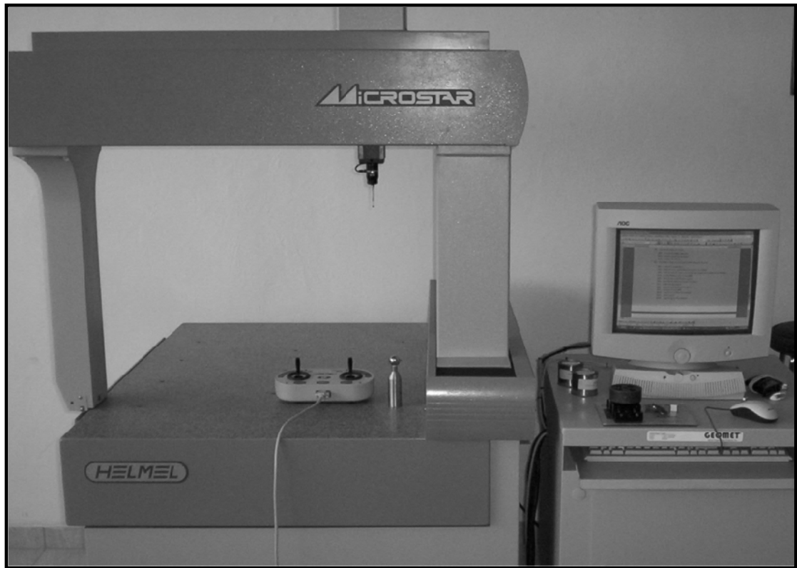
Figura 5.6. Definición del sistema de coordenadas pieza.
