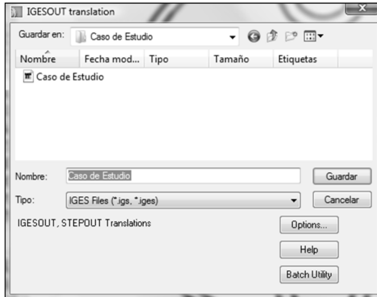
Figura 5.41. Creación del formato neutro IGES del modelo CAD.
