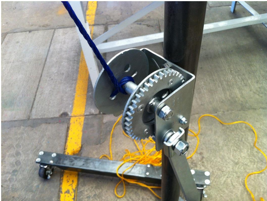
Figura 5.32 Sujeción del malacate a la columna principal
