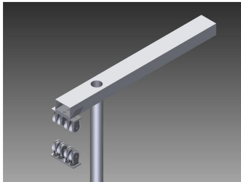
Figura 5.21 Polipasto montado en la columna principal
