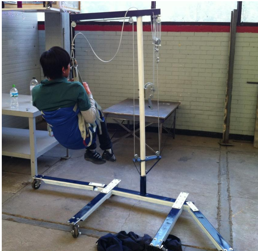
Figura 5.35 Dispositivo de traslado de pacientes terminado
