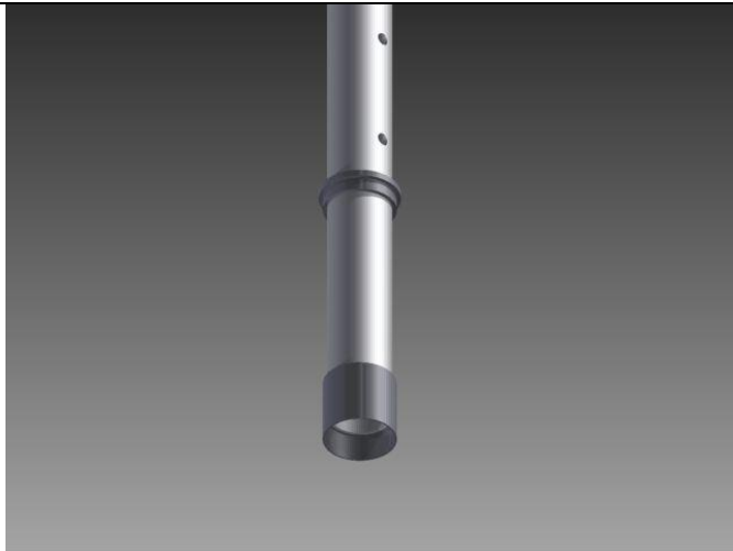
Figura 5.12 Centrado de la columna con los bujes
