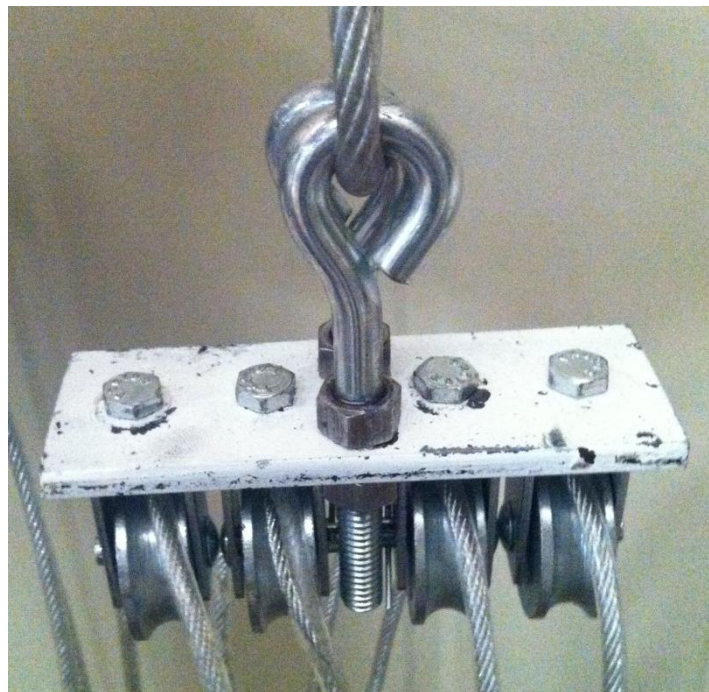
Figura 5.33 Polipasto (sistema móvil de poleas)
