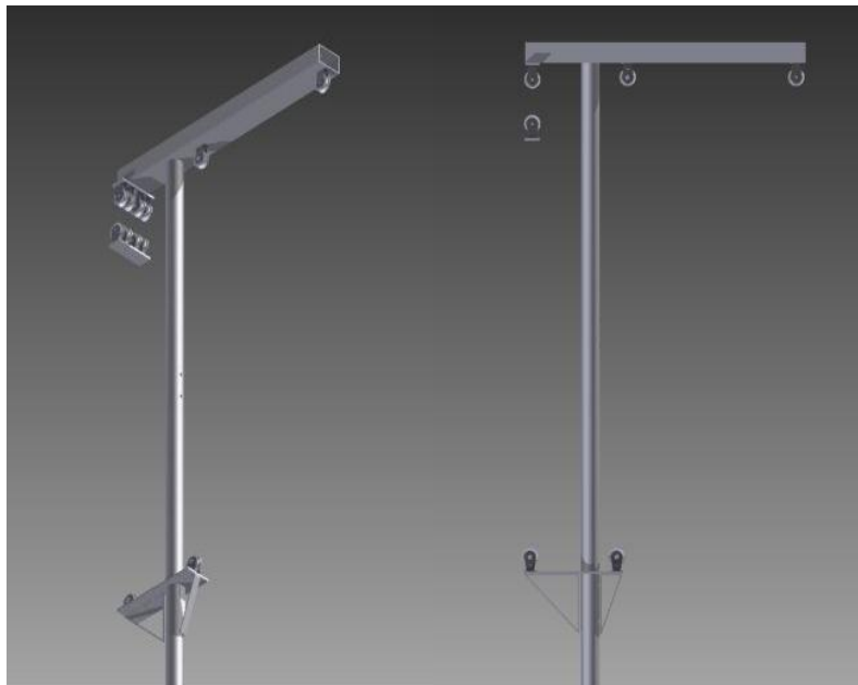
Figura 5.28 Sistema de elevación del paciente
