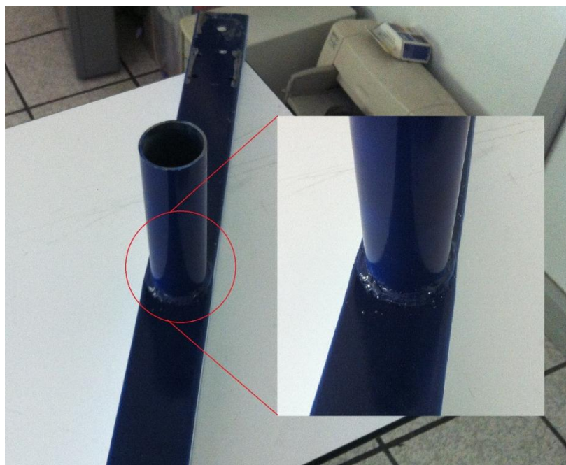
Figura 5.41 Deformación en la parte media del travesaño
