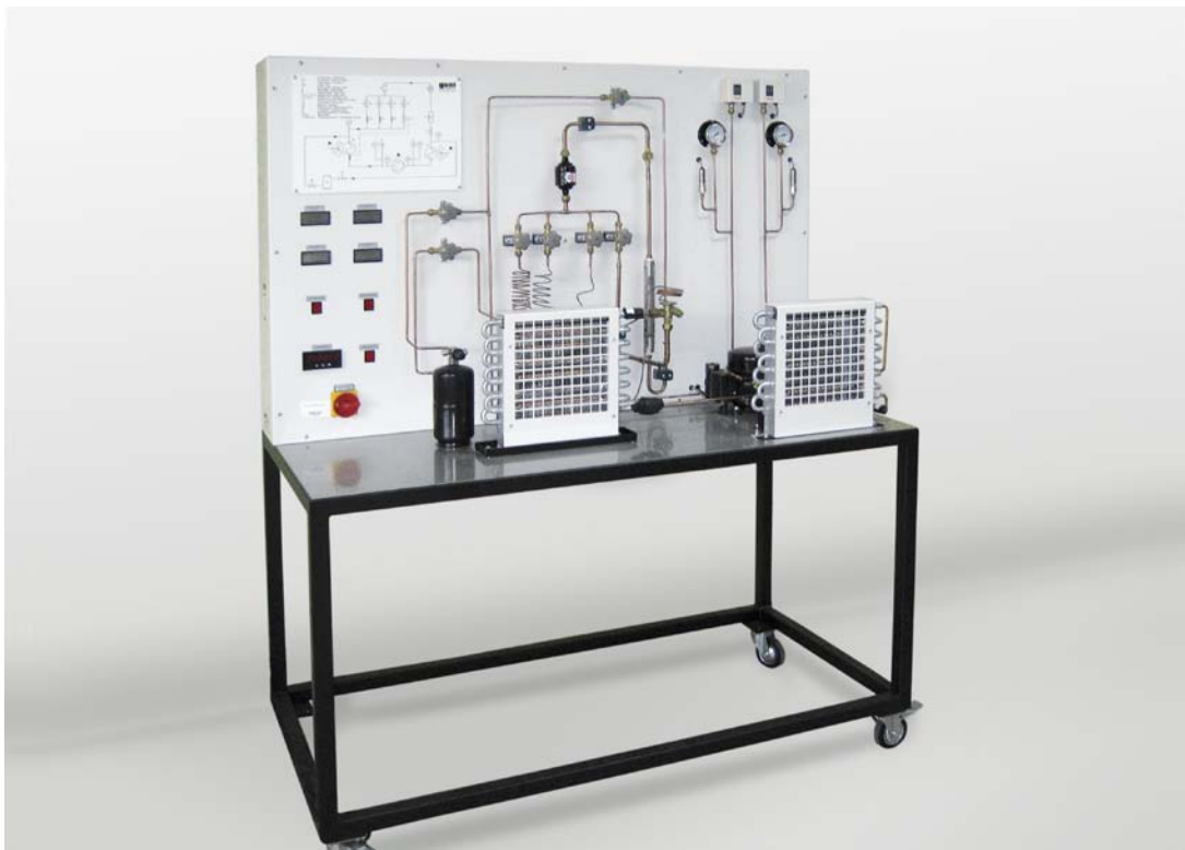
Figura 8. Instalación frigorífica de compresión ( Gunt HAMBURG ).
