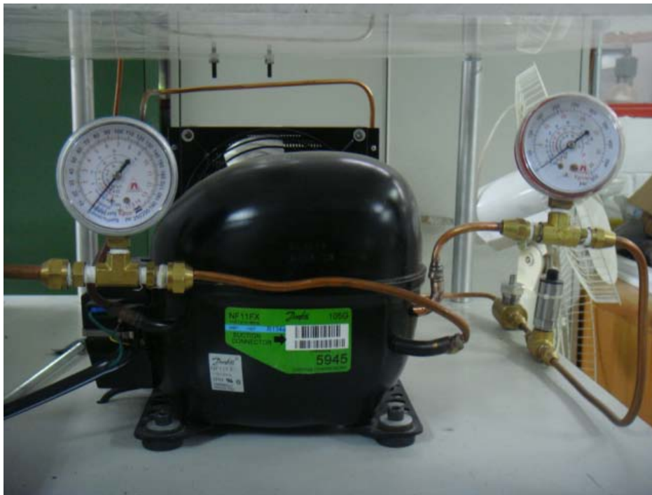
Figura 10. Compresor tipo hermético.
