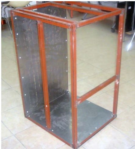
Figura 13. Estructura del espacio a refrigerar.
