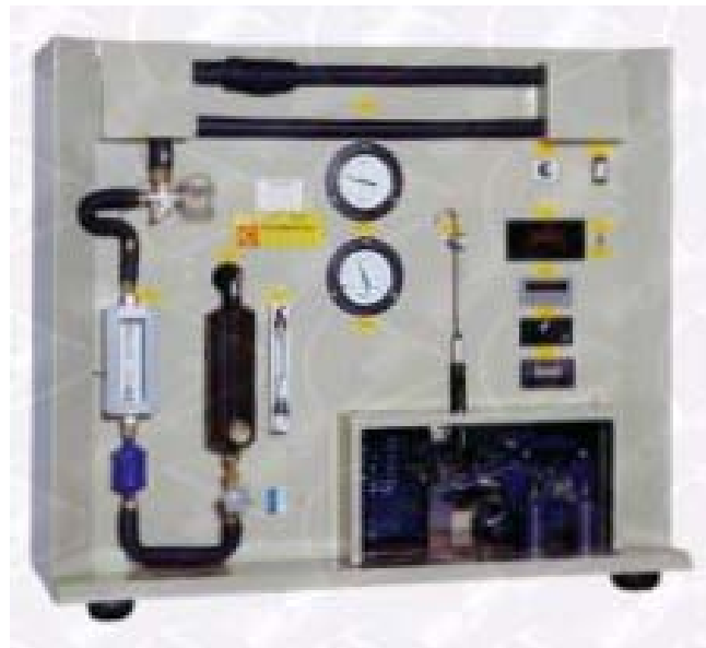
Figura 4. Unidad de refrigeración de laboratorio.
