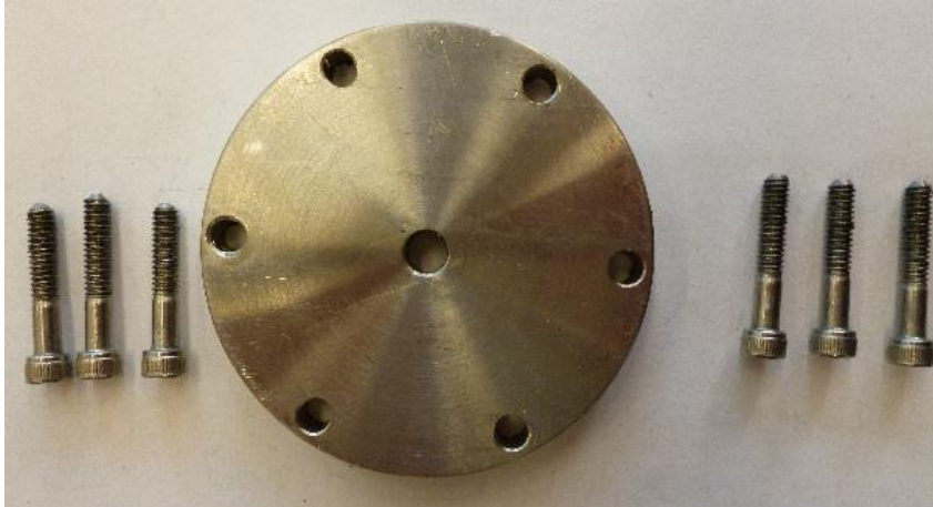
Figura 3.17 Tapa del cilindro y tornillos de fijación
