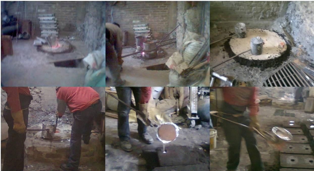
Figura 3.17. Collage de las etapas de fusión y vaciado del material.
