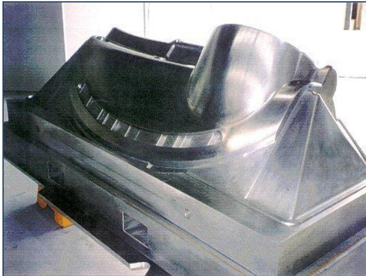
Figura 2.9. Ejemplo de molde fundido en aluminio.
