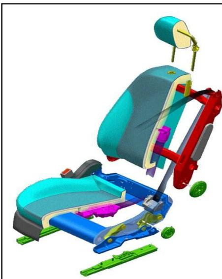
Figura 2.14. Partes principales de un modulo de asiento para auto (Cortesía Lear, Co.).
