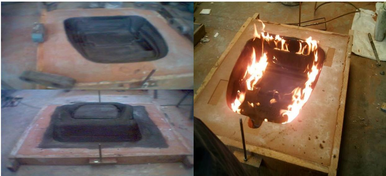
Figura 3.15. Izquierda: Pintura selladora del grano de arena. Derecha: Quemado de residuos de pintura.
