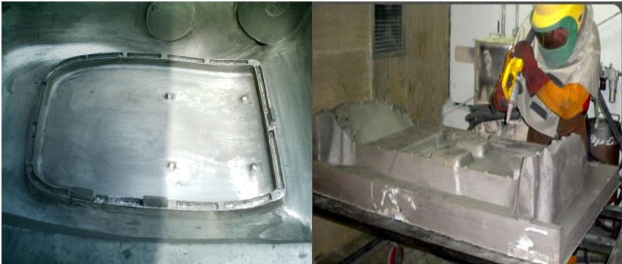
Figura 3.20. Izquierda: Cavidad del molde pulida. Derecha: Operario realizando pulido del molde.
