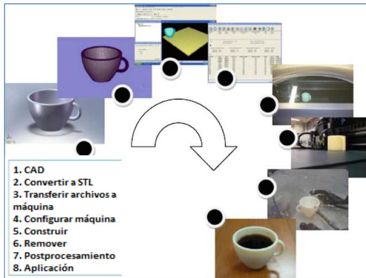
Figura 4.12. Pasos a seguir en la obtención de un modelo a través de la impresión 3D.
