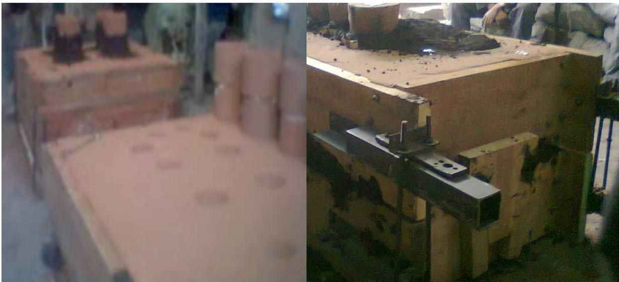
Figura 3.16. Izquierda: Molde de arena listo para vaciar. Derecha: Molde con dispositivos de sujeción.
