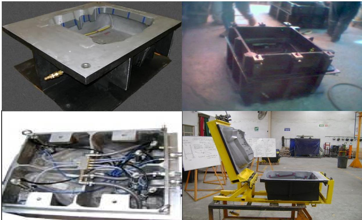
Figura 3.24. Muestra del molde terminado pintado con herrajes y su portamolde.
