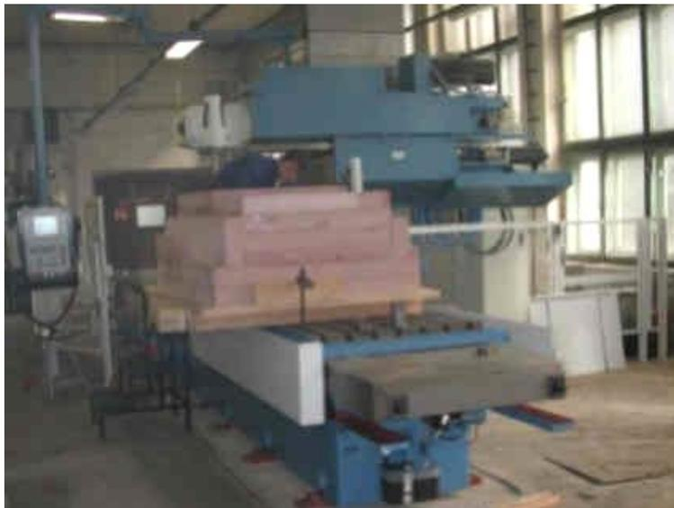
Figura 4.9. Preparación y montaje de modelo de Resina en centro de maquinado.
