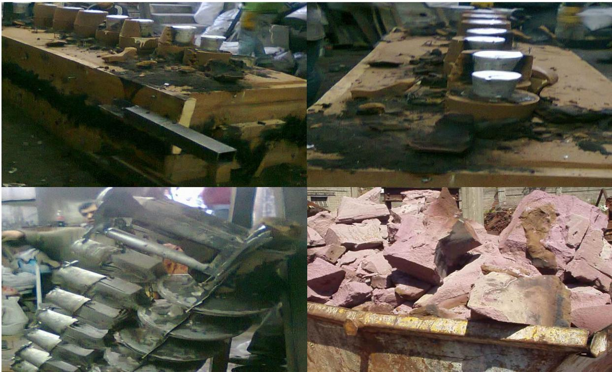
Figura 3.18. Superior: Solidificación de material. Inferior: Limpieza y remoción del molde metálico.
