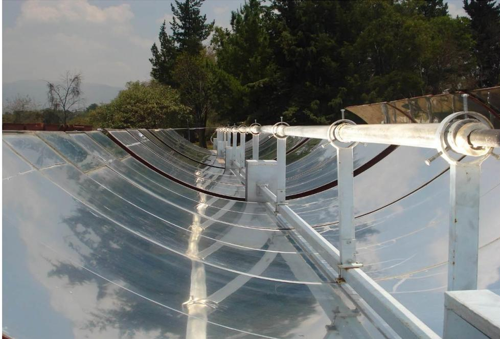
*Figura 1.6 Foto de Concentrador de canal parabólico simple, ubicado en la Planta Solar del Instituto de Ingeniería, UNAM*
