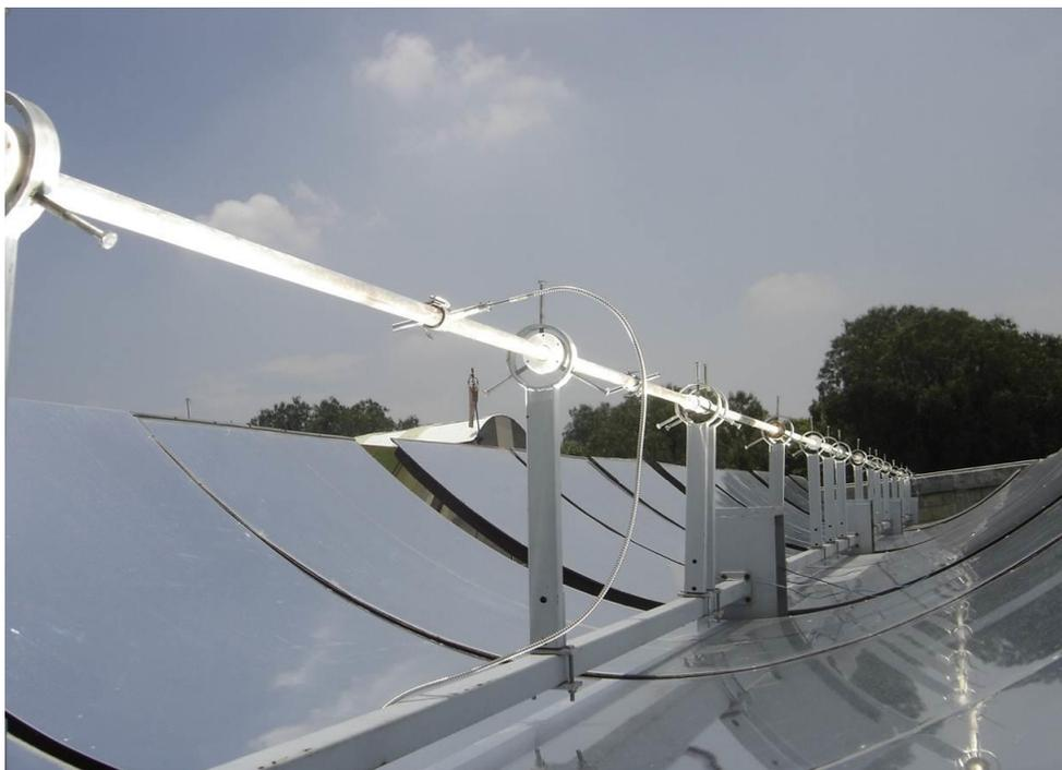
*Figura 1.10. Fotografía de Concentrador parabólico simple, acondicionado para fotocátalisis solar. Planta Solar del Instituto de Ingeniería, UNAM.*
