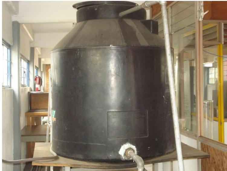
*Figura 2.13. Fotografía del depósito del fluido de trabajo, utilizado como contenedor del fluido de trabajo en la recirculación*
