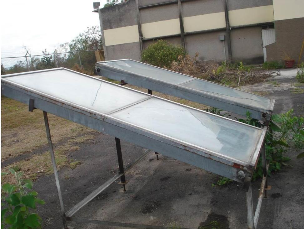
*Figura 1.5 Fotografía de un Colector Solar Simple, ubicado en la Planta Solar del Instituto de Ingeniería, UNAM.*
