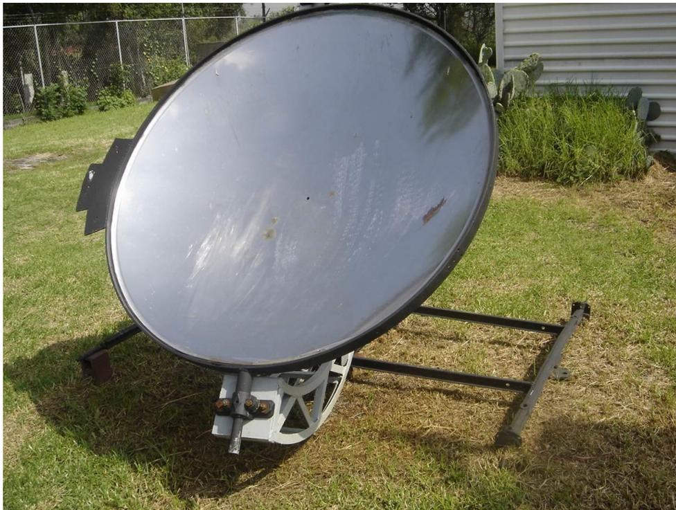
*Figura 1.8. Concentrador solar puntual. Ubicado en la Planta Solar del Instituto de Ingeniería, UNAM, México D.F.*
