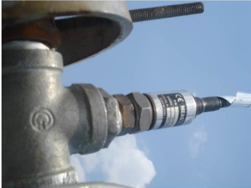
*Figura 2.9 Fotografía de Transductor de presión a la entrada y a la salida del medio de prueba.*
