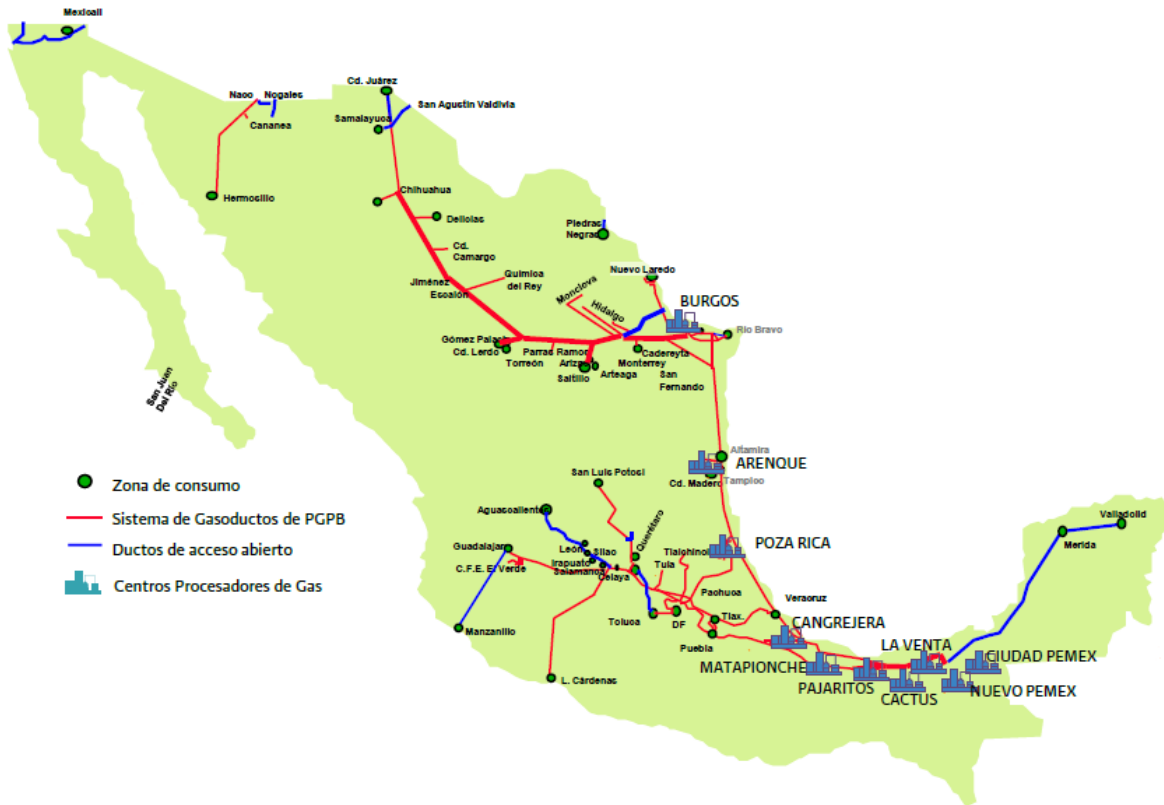
Ilustración 25 Red de ductos y centros procesadores de gas, diciembre, 2011 Fuente: Prospectiva del Mercado de Gas Natural 2012-2026 SENER
