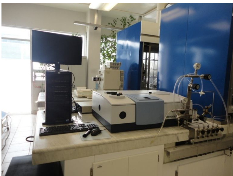
Figura 14 FT-IR Vertex 70 ubicado en el laboratorio de catálisis y energía de la BUAP.
